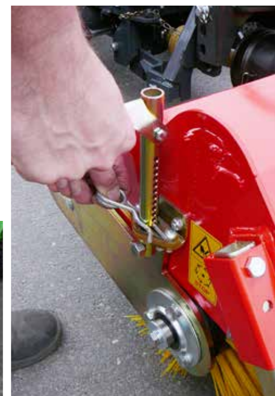
Bürstenverstellung über Stecksystem
