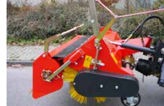
K 450 mit mechanischer Behälterentleerung
