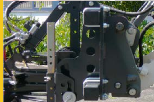
Hofladeraufnahme mit Niveaueingleich und Abstellstütze
