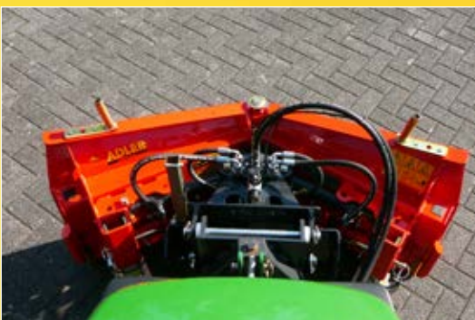
Alle Räummöglichkeiten in V-, Y- und Diagonaleinstellung
