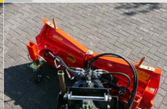
Hofladeraufnahme mit Niveaueingleich und Abstellstütze
