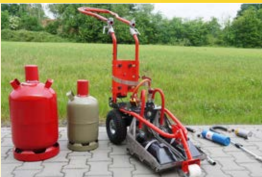
Der Flexi kann mit einer 11-kg- oder 5-kg-Gasflasche betrieben werden. Für den Handbrenner gibt es nachfüllbare Gasflaschen und Einwegkartuschen.
