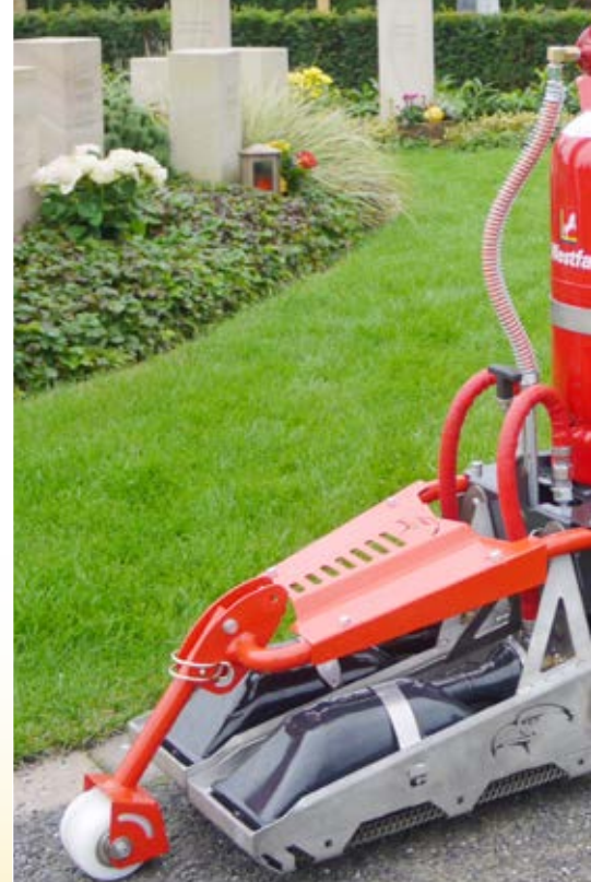
Durch die vordere Laufrolle werden die Infrarotstrahler in der optimalen Arbeitshöhe geführt.
