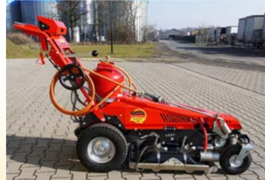
Große Antriebsräder und Differential-Getriebe sorgen für eine hohe Wendigkeit und leichtes Arbeiten
