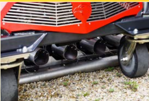
Stoß- und Schwerlastlenkrollen zum Schutz der Infrabox
