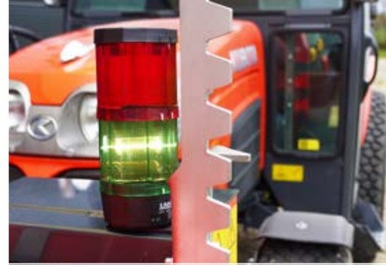
Anzeiger zur Höheneinstellung und Signalleuchten zur Betriebskontrolle der Infrabox
