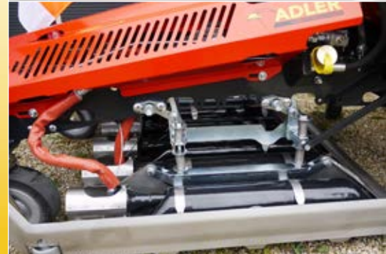
Federnd gelagerte und per Funkfernbedienung höhenverstellbare Infrabox
