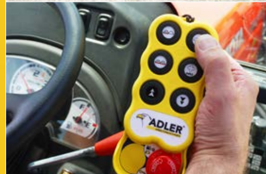
Funkfernbedienung mit Saugnapfhalterung und Notaus
