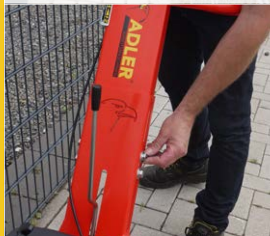
Stufenlose Höheneinstellung des Lenkholmes
