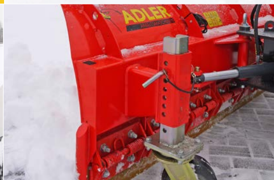
Höhenverstellbare Stützräder (200 mm x 80 mm)
