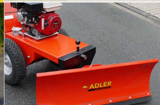
Handkehrmaschine mit Schneeräumschild
