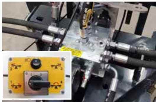
Elektrisches Umschaltventil + Überlastsicherung = Komfort-Steuerung
