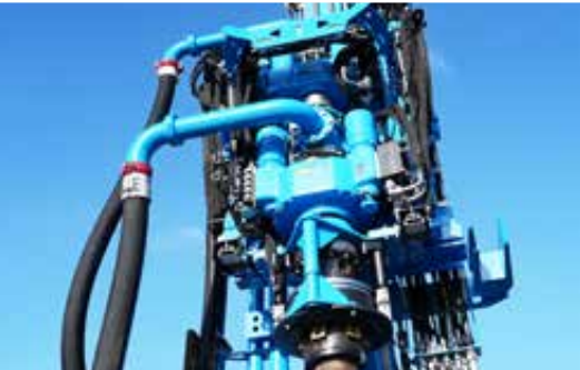
Doppelkopfbohrantrieb mit Spannglocke zum gleichzeitigen abteufen vom Bohrrohr und Außenverrohrung bei Überlagerungsbohrungen
