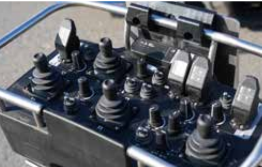
Ergonomische Fernbedienung für den kompletten Fahr- und Bohrbetrieb
