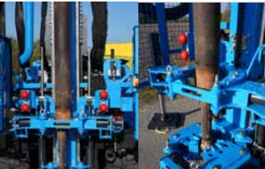
Klemmbrechhubschelle zum einfachen Brechen des Bohrgestänges und der Außenverrohrung mit Schutzrohrklemme unten
