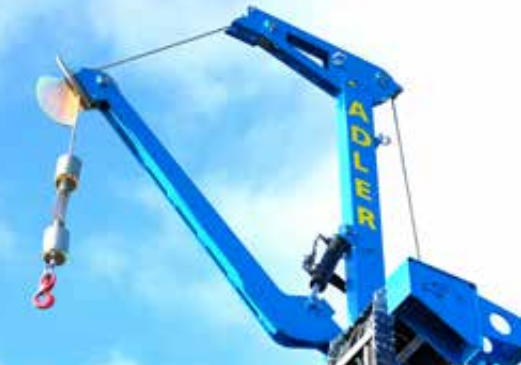
Hydraulischer Mastausleger mit einer Hakenlast von 17,5 kN zum bequemen Zuführen des Bohrwerkzeuges
