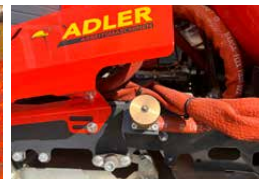
Seitlicher Füllstutzen für LPG-Autogas
