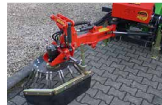
Schwerer Bürstenkopf mit seitlichem Schleuderschutz
