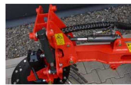
Hydraulisch einstellbare Längs- und Querneigung, wahlweise auch mechanisch
