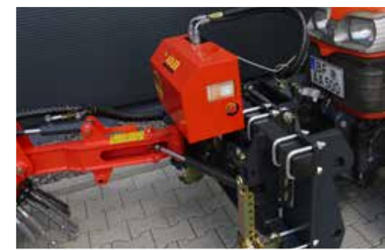
Universalanbau mit Seitenausschwenkung
