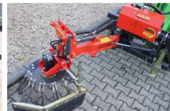
Hydraulisch einstellbare Längs- und Querneigung, wahlweise auch mechanisch
