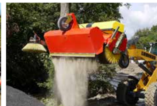
Vidange hydraulique du bac collecteur des déchets
