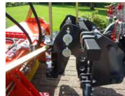
Attelage valet de ferme avec système de trous oblongs et Compensation 3D
