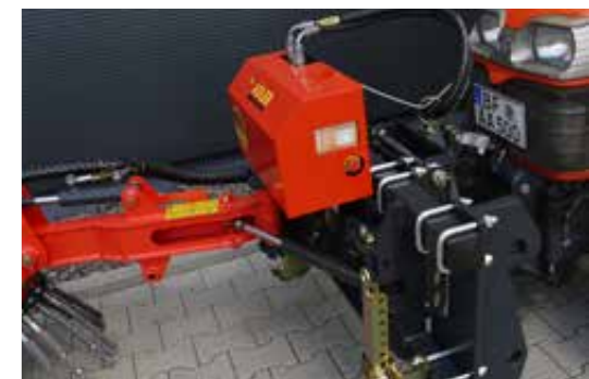
Attelage universel avec orientation latérale
