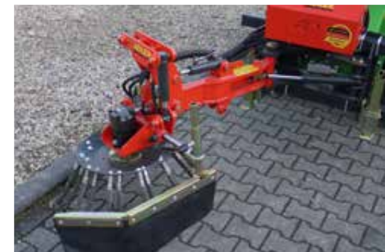
Tête de brosse lourde avec protection latérale contre les projections
