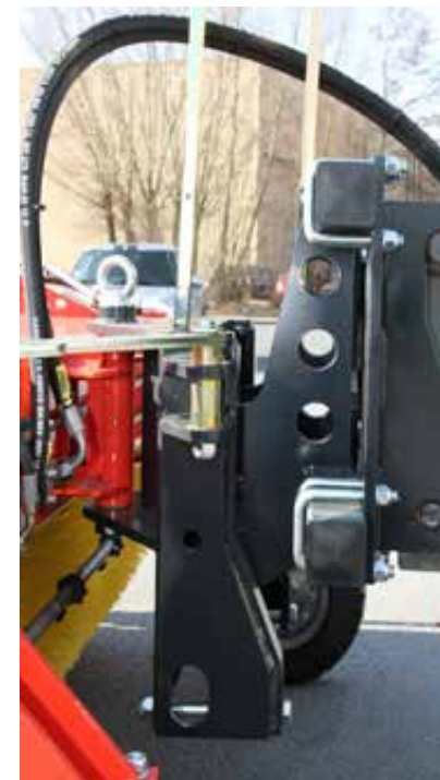
Attelage pour chargeurs à roues avec glissière à roulements à billes et compensation 3D
