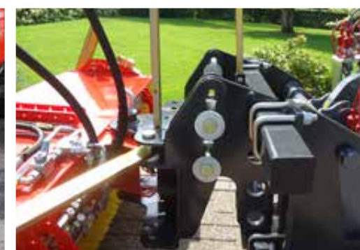
Attelage universel avec compensation de niveau 3D
