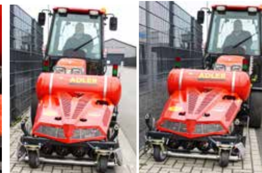
Décalage latéral hydraulique de 20 cm à droite et à gauche
