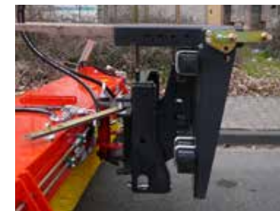
Attelage pour chargeurs à roues avec glissière à roulements à billes et compensation 3D
