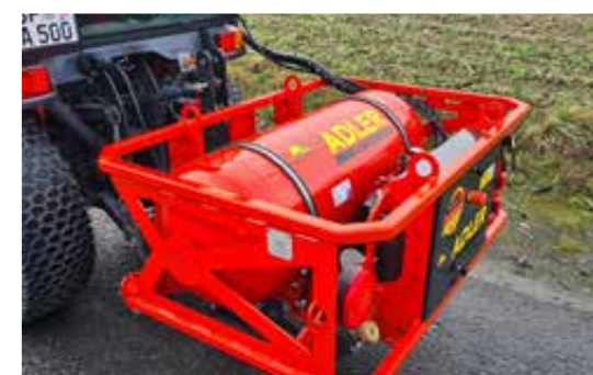
Support de réservoir arrière pour réservoirs de gaz de 80 l et 120 l
