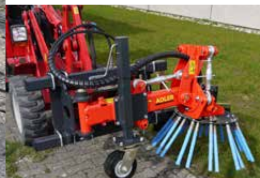
Bras pivotant (mécanique / hydraulique) pour le traitement de grandes surfaces
