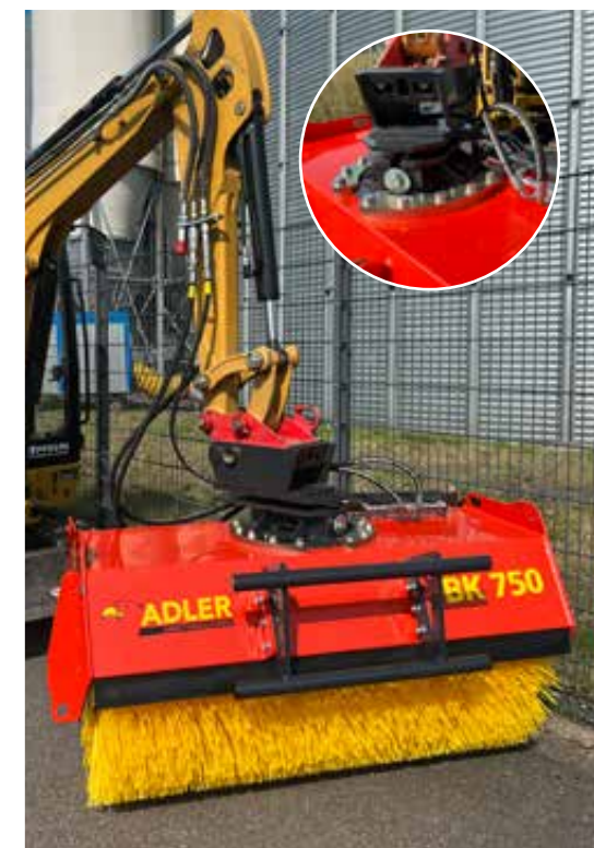
Couronne d'orientation pour faire pivoter la machine de 90° – hydrauliquement ou mécaniquement
