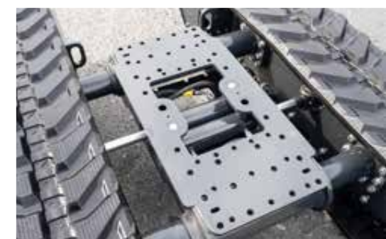
La partie centrale des trains de roulement tient beaucoup de points de vissage, qui peuvent être utilisés individuellement selon les besoins des clients.
