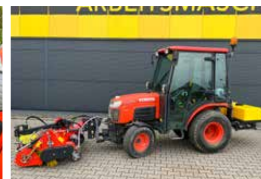
Système de pulvérisation d'eau (120 l ou 300 l) sur le porte-bagages arrière en option
