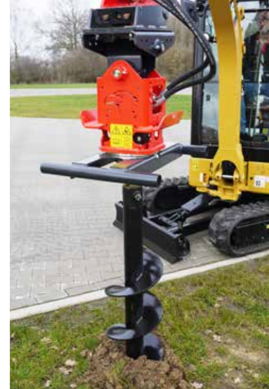
Tarière E 100 avec broche de forage Ø 250
