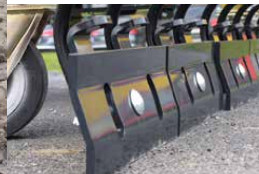
Les racles à suspension pendulaire s'adaptent de manière optimale aux irrégularités de la chaussée
