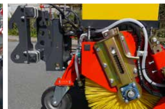
Attelage universel lourd avec compensation de niveau 3D par guidage à rouleaux
