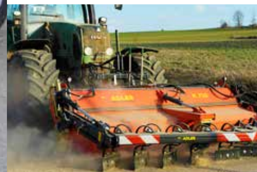
K 750 avec racloir et bac collecteur des déchets
