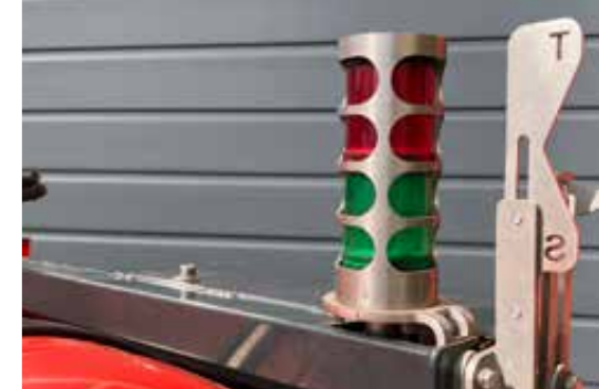
Indicateur de réglage de la hauteur et voyants de signalisation pour le contrôle du fonctionnement des émetteurs infrarouges
