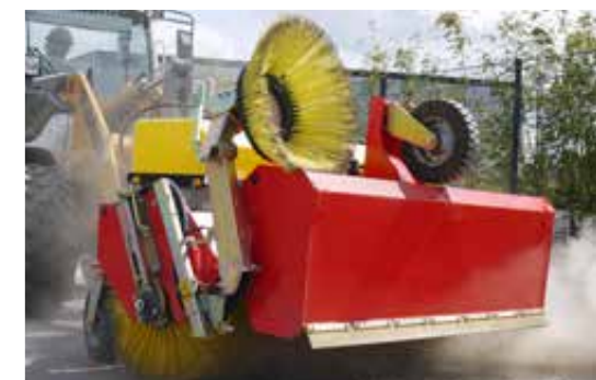
Mode de déblaiement simple et diamètre de brosse 750 mm de série
