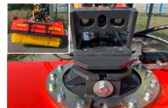
Le pendule à ressort s'adapte au sol de manière optimale
