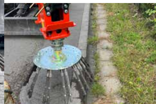
Rotation à droite/gauche de série pour des applications individuelles de nettoyage
