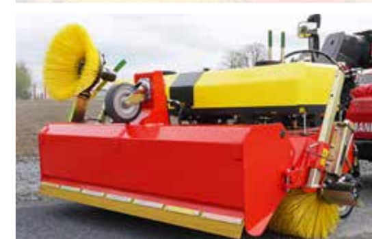
Mode de balayage simple, vidange hydraulique et troisième roues de support du bac collecteur
