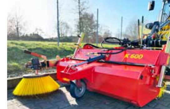
Brosse latérale et système de pulvérisation d'eau en option
