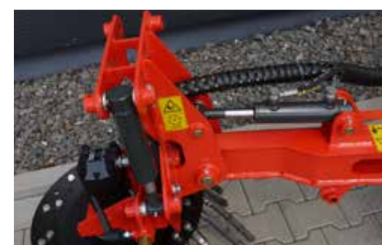
Inclinaison longitudinale et transversale à réglage hydraulique ou mécanique
