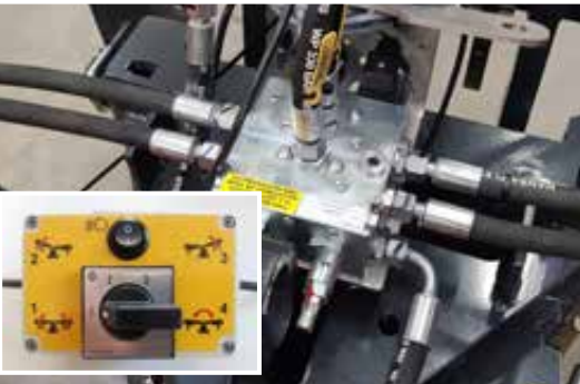
Vanne de commutation électrique + sécurité contre les surcharges = Commande confort
