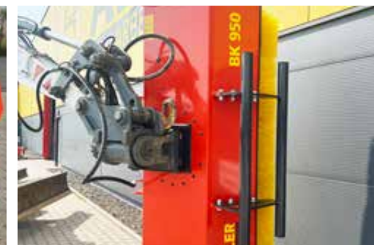
Insert pour une utilisation verticale avec fonction « Powertilt » sur la pelle
