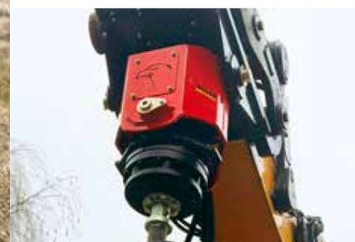
Krchtige radiale plunjermotoren met hoog rendement ...
