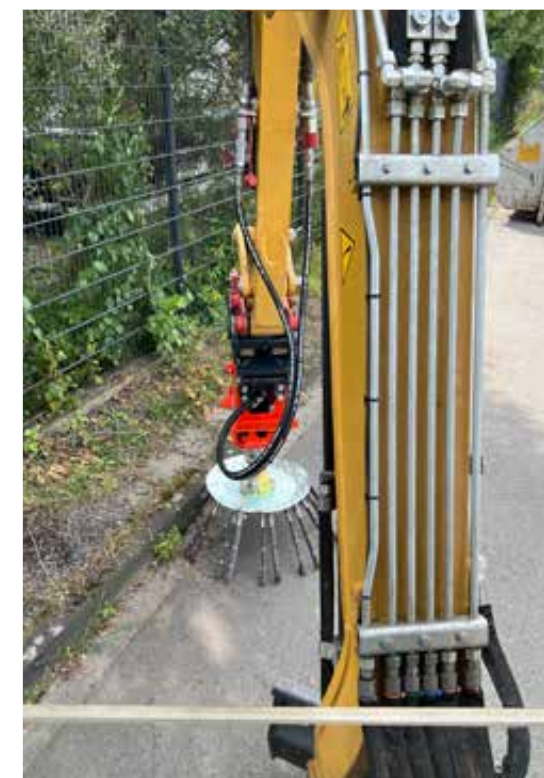
Optimaal zicht op de BW 800 onkruidborstel vanuit de cabine
