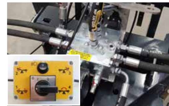
Elektrisch omschakelventiel + overdrukventiel = comfortbediening
