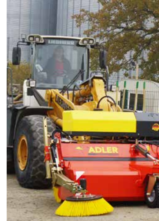
Een watersproei-installatie, dan wordt de zijborstel altijd met een sproeidop uitgevoerd!
