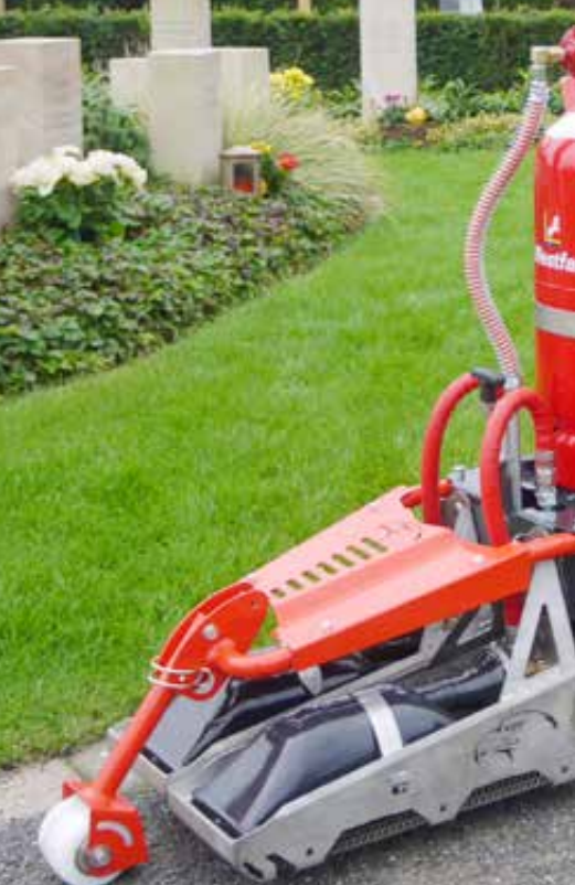
Door de voorste looprol worden de Infraroodstralers in optimale werkpositie geleid.
