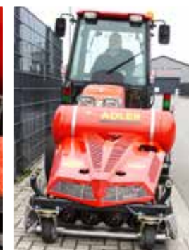
Hydraulische side-shift 20 cm zowel links als rechts
