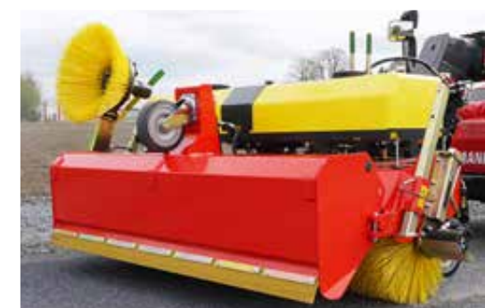
Vegen onder de bak door. Opvangbak hydraulisch kliepend met 3e steunwiel
