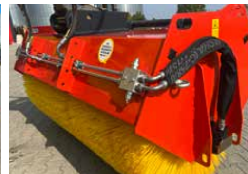
Krachtige hydrauliek motoren met naloopbeveiliging
