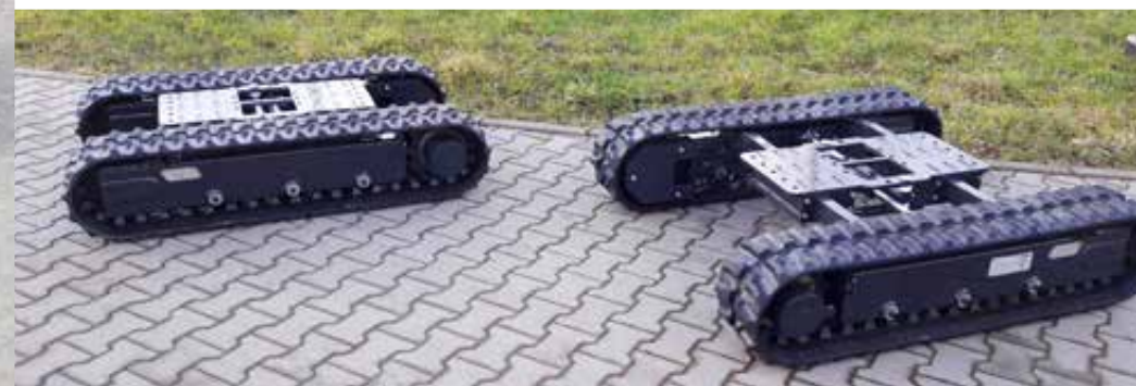
De rijwerken kunnen naar keuze besteld worden: hydraulisch telescopisch of zonder middendeel
