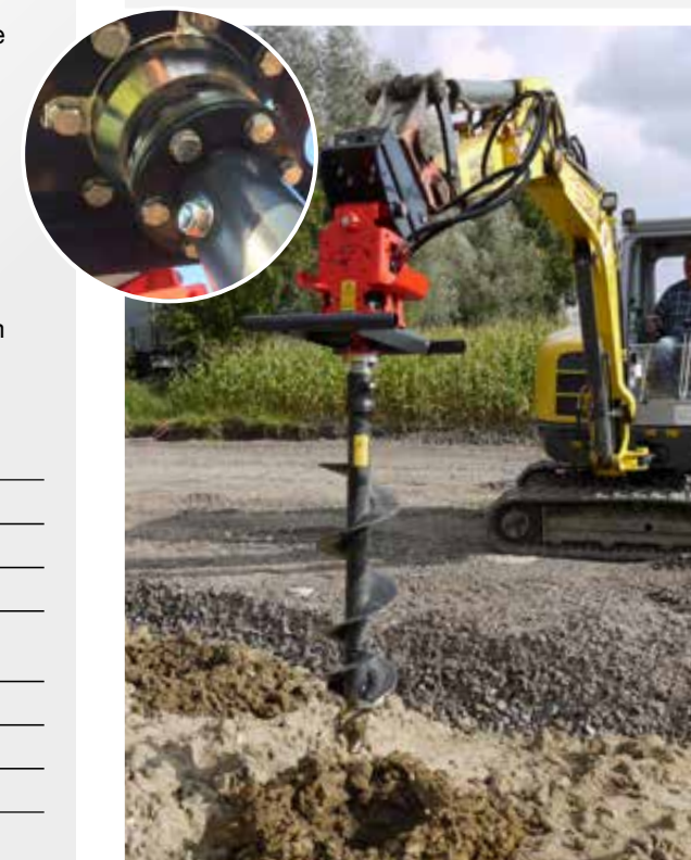
Dubbel scharnierpunt en voorzetlager
