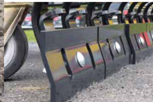
De pendelend opgehangen beitels passen zich op een oneven wegdek optimaal aan
