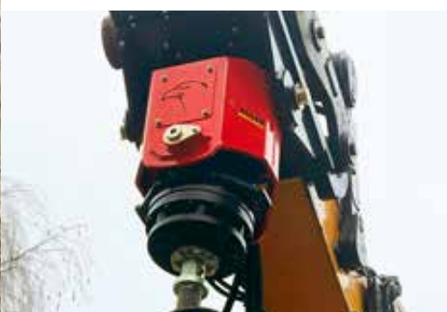
Krchtige radiale plunjermotoren met hoog rendement ...
