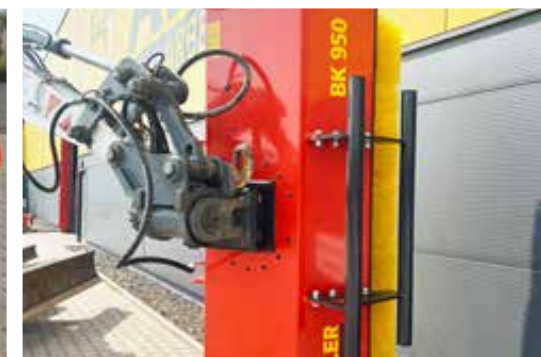
Gebruiken voor verticale reiniging met Powertilt functie aan kraan
