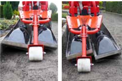
Ideaal om kanten te bewerken is de schuinverstelling van de stralers naar links of rechts
