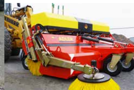
Hydraulisch klapbare en inschakelbare zijborstel (Ø 900 mm).
