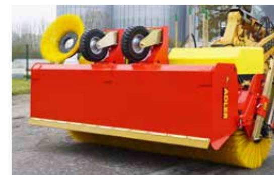
Vegen onder de opvangbak geactiveerd door de afstandbediening!
