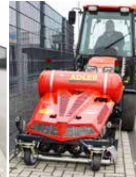
Hydraulische side-shift 20 cm zowel links als rechts
