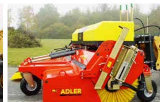
Vier grote zwenkwielen (460 x 125 mm) zorgen voor meer stabiliteit tijdens het vegen.
