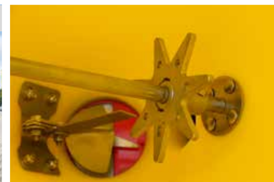
Het door ADLER ontwikkelde klop en roervijzel systeem om brugvorming tegen te gaan
