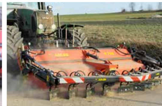
Aangebouwde combinatie met veegmachine K 750 met opvangbak
