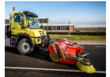
Unimog opname met hefinrichting DIN 3/5
