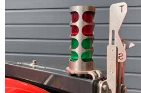
Indicator voor hoogte verstelling en controle lampen voor de infrabox
