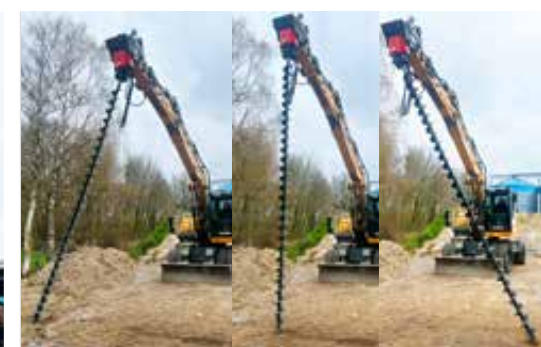
Eenvoudige bediening – dankzij de grote geïntegreerde 2D-pendelweg
