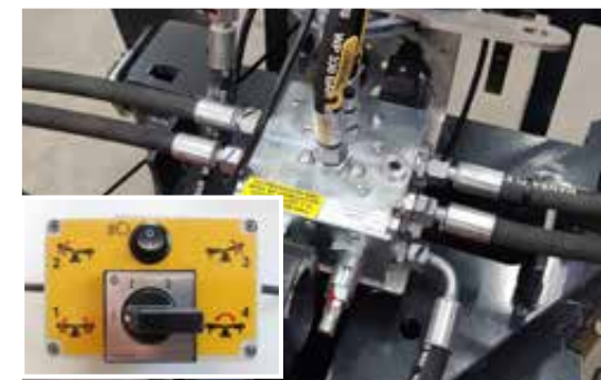
Elektrisch omschakelventiel + overdrukventiel = comfortbediening
