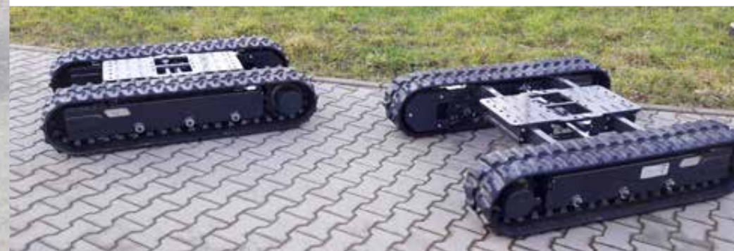
De rijwerken kunnen naar keuze besteld worden: hydraulisch telescopisch of zonder middendeel
