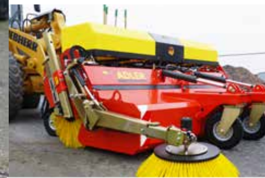
Hydraulisch klapbare en inschakelbare zijborstel (Ø 900 mm).
