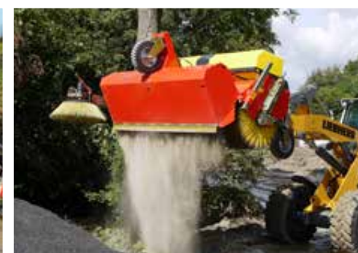
Hydraulisch legen van de vuilopvangbak
