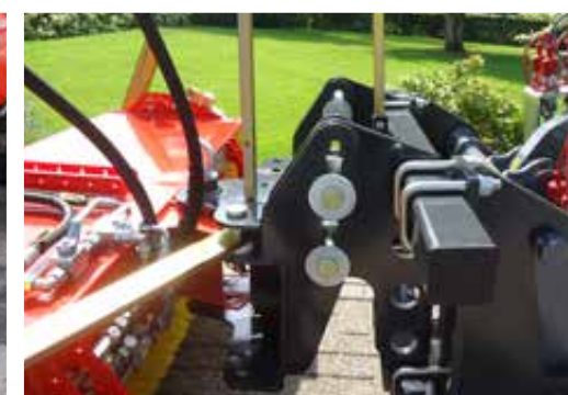
Universele opname met 3D niveauregeling
