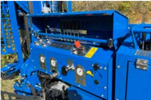
Bedienstandschutzhaube mit Beleuchtung
