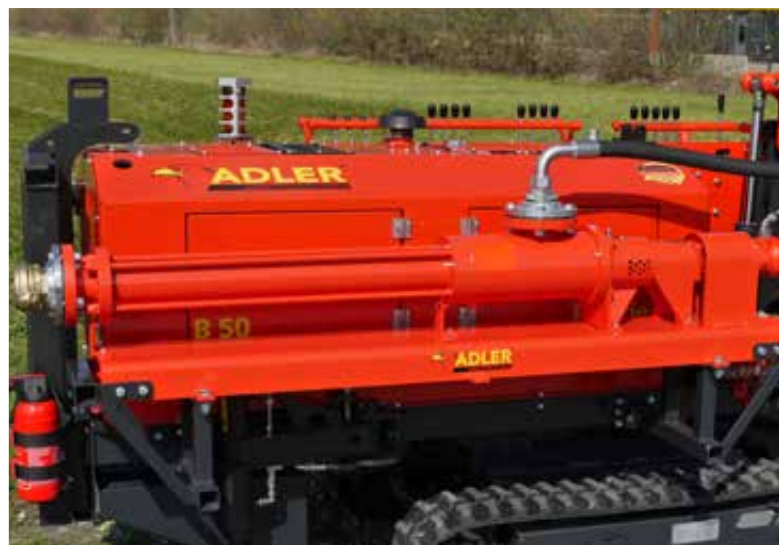
Schneckenpumpe im Einsatz beim Doppelkernrohrbohren
