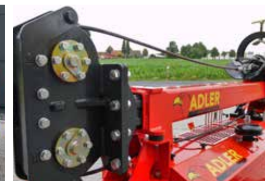
Abgelegter Mast mit Fallgewichtsarretierung
