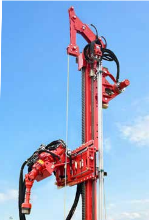
Mehrstufiger Bohrantrieb, klappbar inkl. Seilwinde mit Schlageinrichtung und Mastverlängerung
