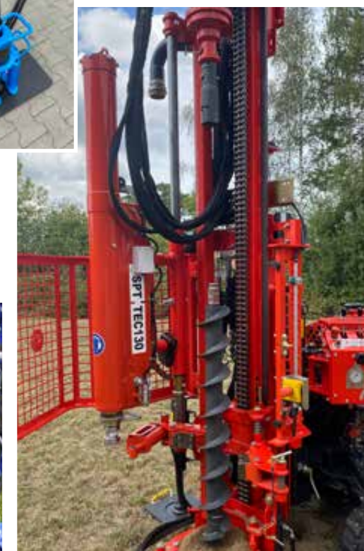
Geologische Sondierung mit der Rammsondiereinheit oder der Hohlbohrschnecke sind im Wechsel möglich
