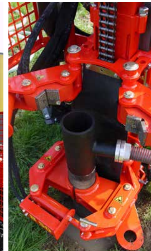
Wasserablauf beim Kernbohren
