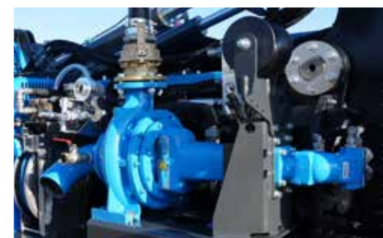
Leistungsstarke Wasserpumpe mit bis zu 120 m³/h oder max. 12 bar
