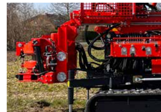
Verrohrungsdrehtisch in Transportstellung
