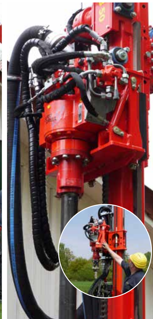
2-stufiger Spülbohrkopf mit Ausschwenkfunktion am B 50
