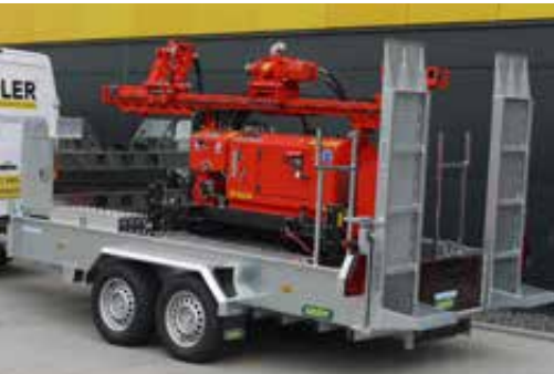
Systemanhänger für Bohrgeräte – alles hat seinen Platz
