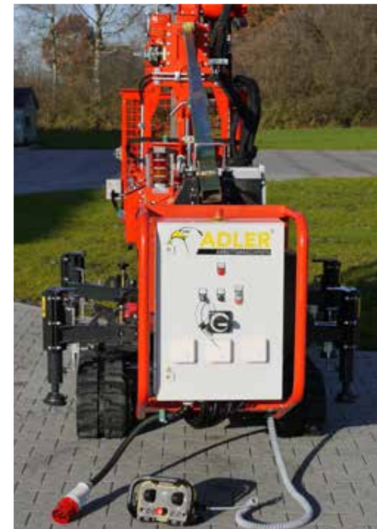
Elektroschaltschrank mit drei CEE Steckdosen (Ausgang)
