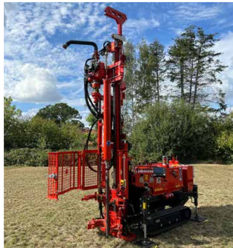
B 25 ausgerüstet mit Rammsondiereinheit
