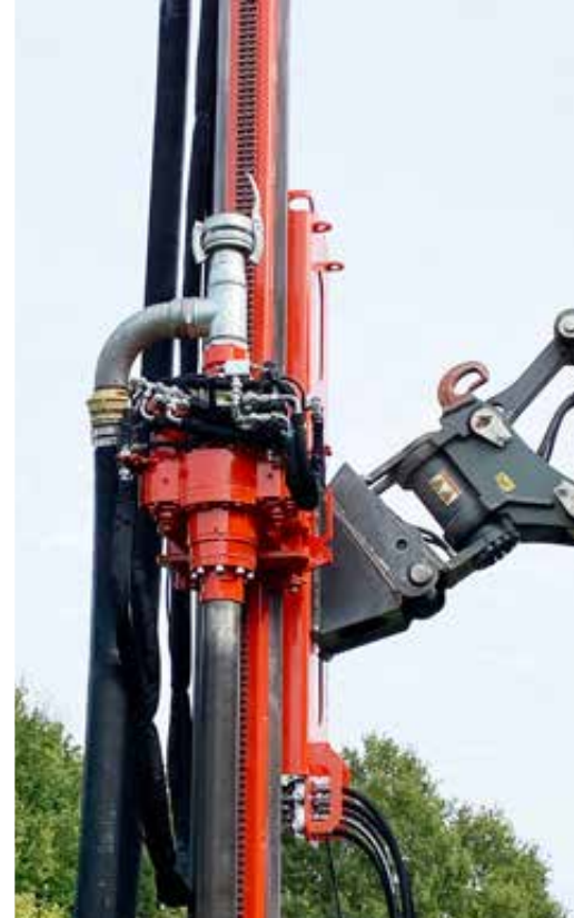
ADLER-Getriebebohrkopf mit Einlass für Filterrohre
