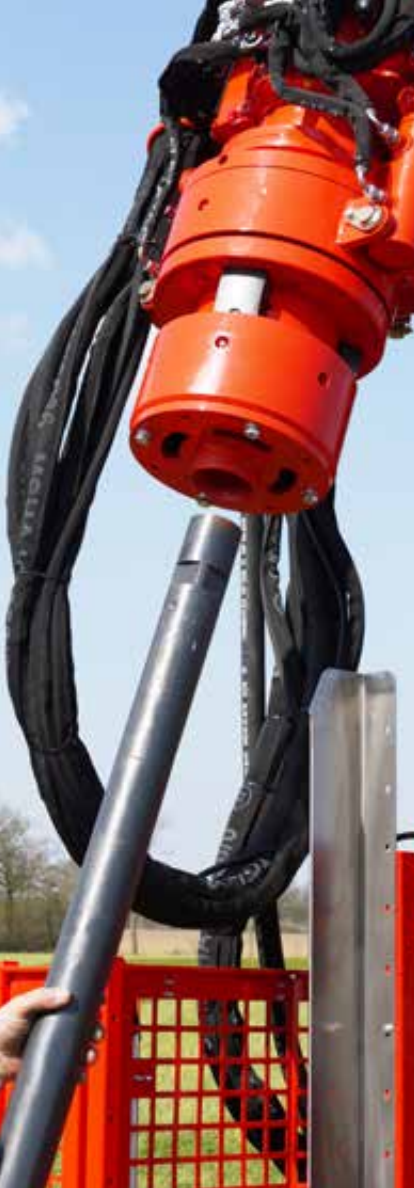
Hydraulische Spannglocke (groß/klein) und zum Brechen des Bohrgestänges und der Aussenverrohrung bis 178 mm (nur mit großer Spannglocke möglich)
