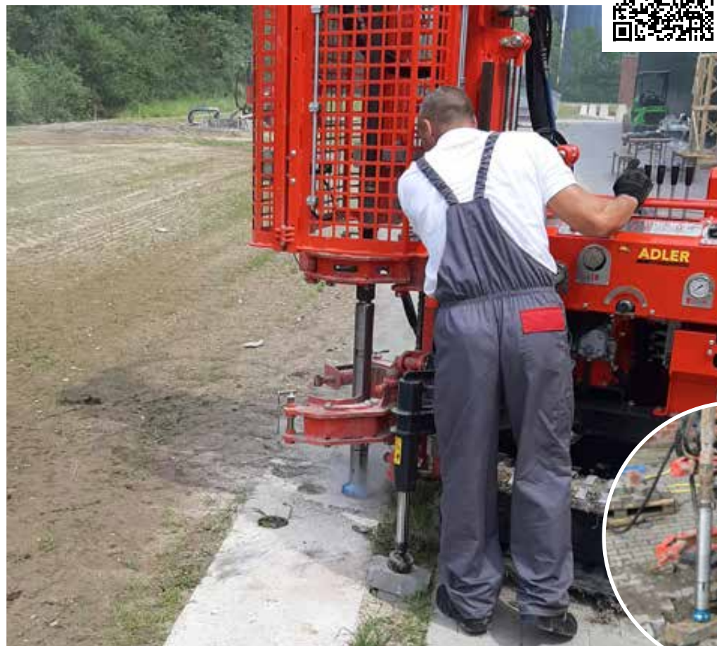
B 50 mit Imlochhammerausrüstung
