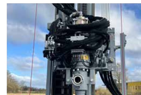
Bohrkopf im Bohrzentrum
