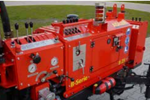
Bedienstand mit allen Bohrfunktionen – schwenkbar
