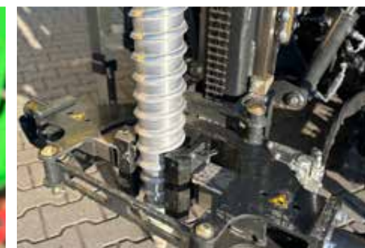
Hydraulische Klemme zum Führen der Schraubfundamente
