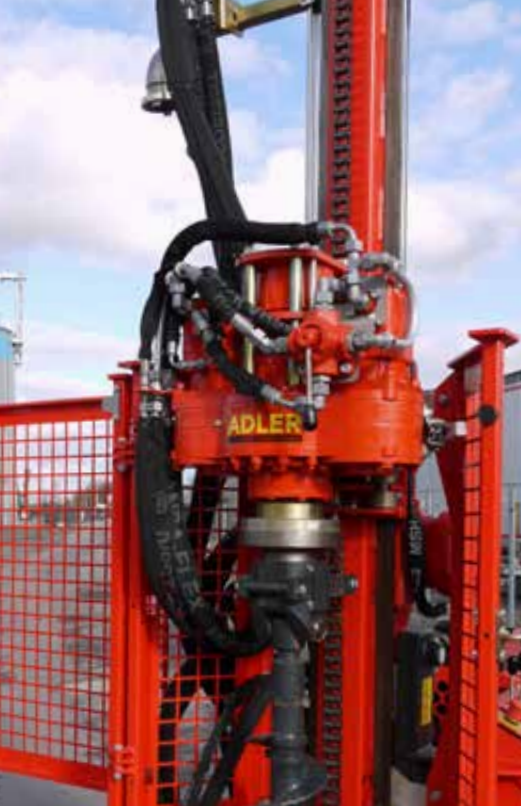
Getriebebohrkopf mit zwei Gängen, mechanisch oder elektrisch schaltbar
