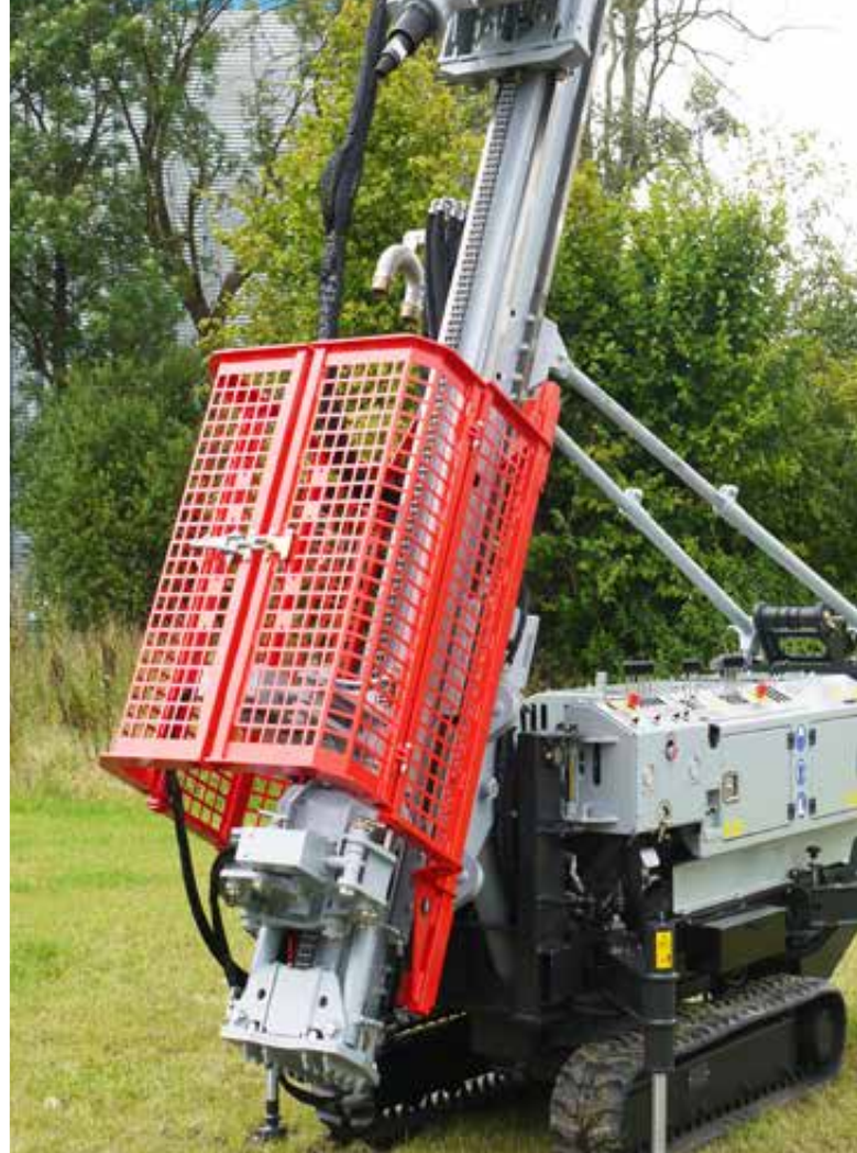
Schrägbohreinrichtung mit Lafettenstützen
