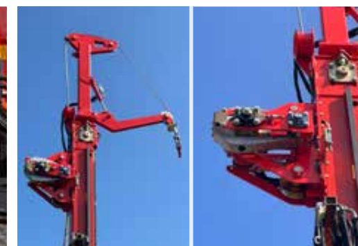
Mastkrone mit Seilschlageinrichtung
