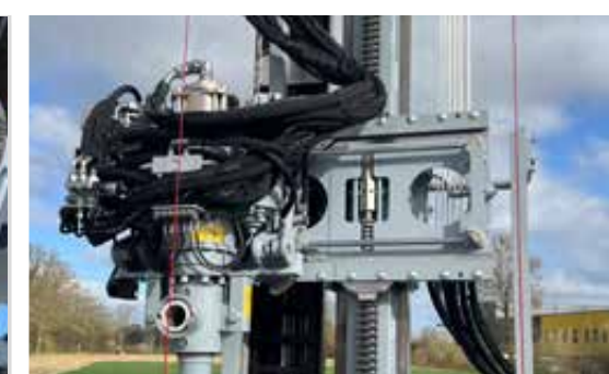
Bohrkopf aus dem Bohrzentrum hydraulisch verschoben
