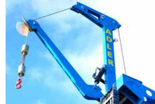
Hydraulischer Mastausleger mit einer Hakenlast von 17,5 kN zum bequemen Zuführen des Bohrwerkzeuges
