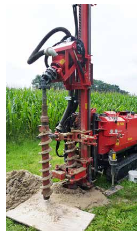
Einfaches Ausbauen der Hohlbohrschnecke durch schwenkbaren Bohrkopf
