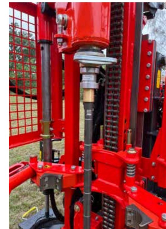
Die Sondiereinheit kann bequem in die Bohrachse geschnwenkt werden
