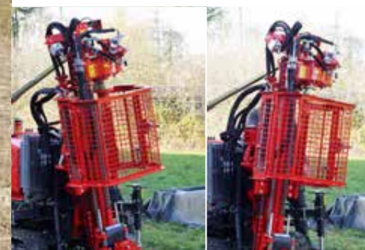
Seitliche Neigung des Bohrmastes (optional)
