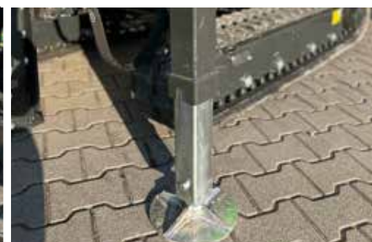
Vier hydraulische Stützfüße serienmäßig
