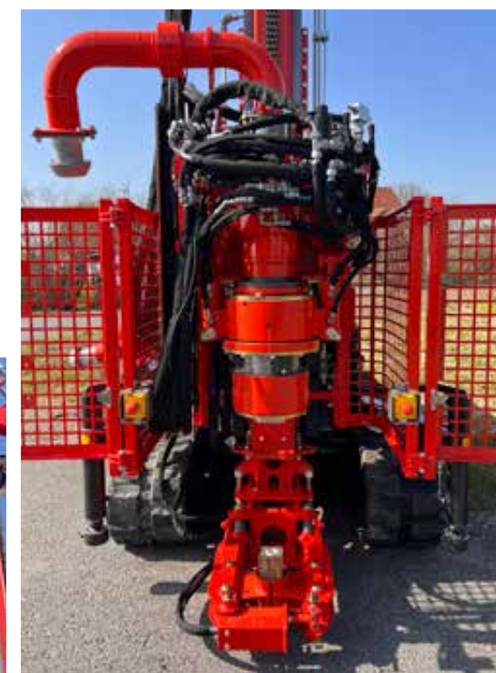
ADLER B 75 geo pro mit Saugbohrausrüstung
