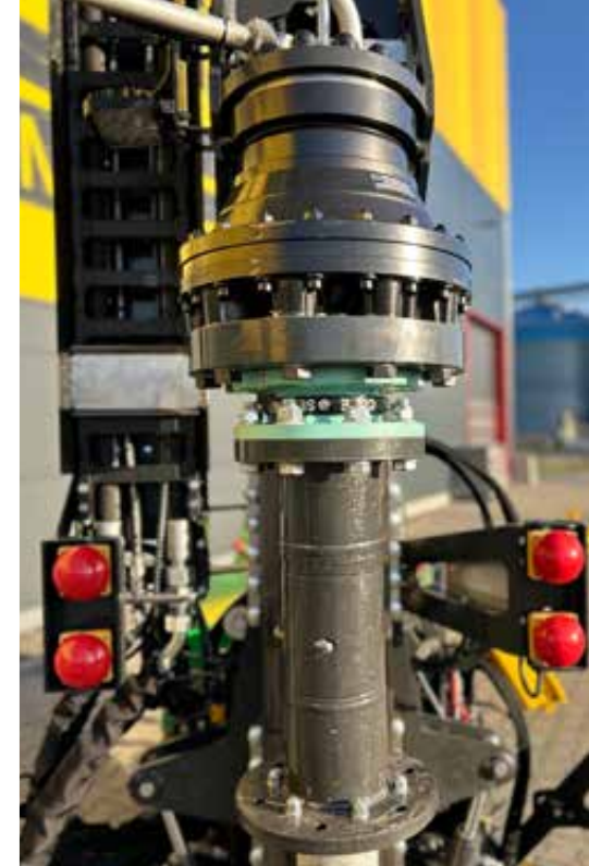
Variabler Bohrkopf mit bis zu 8.000 Nm und mit Schnellwechsellvorrichtung
