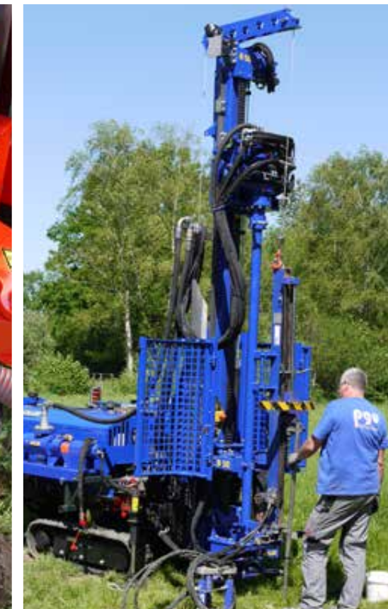
Rammsondieren mit dem ADLER-Borgerät B 50
