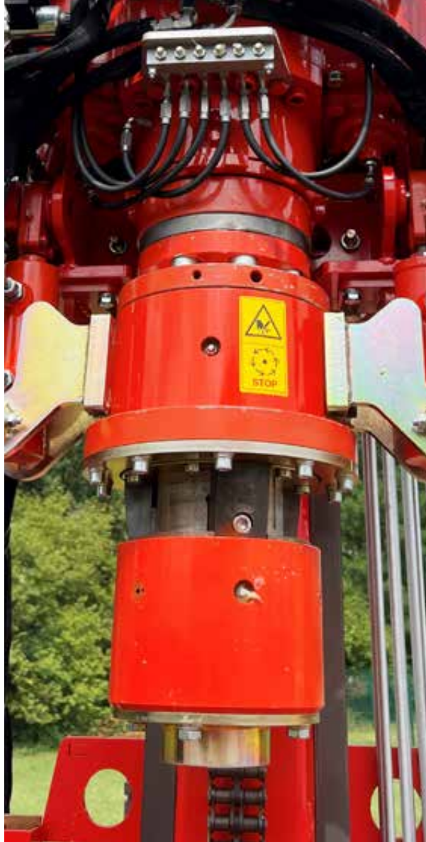
Hydraulische Spannglocke (groß/klein) und zum Brechen des Bohrgestänges und der Aussenverrohrung bis 178 mm (nur mit großer Spannglocke möglich)
