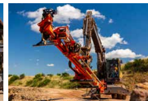
Anbaubohrlafette im Bohrprozess am Bagger
