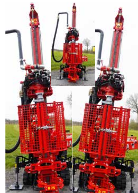
3D-Mastneigung um 5° (nach vorne, oben/unten und seitlich) serienmäßig
