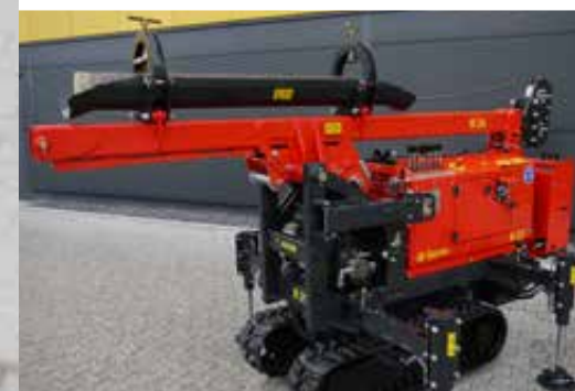
ADLER B 25 – kompaktes und vielseitiges Pfahlrammgerät
