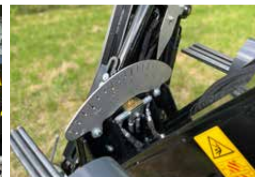
Winkelmeßeinheit für schräges Schlagen
