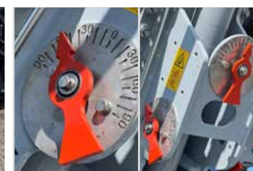
Bohrlafette ausgestattet mit drei mechanischen Winkelanzeigern
