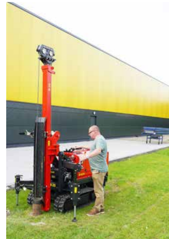
Hydraulische Mastverlängerung 1.000 mm
