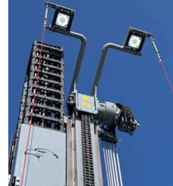
Sicheres Arbeiten auch bei Dunkelheit mit zwei LED-Scheinwerfern
