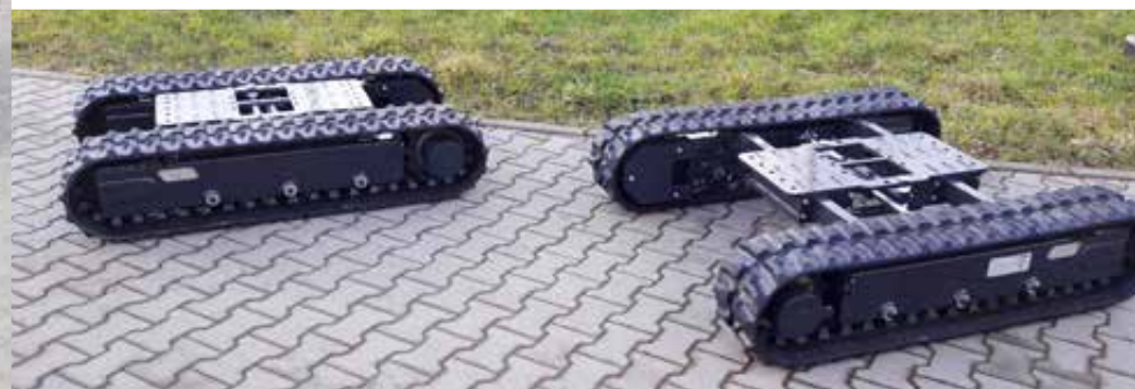
Die Fahrwerke können wahlweise hydraulisch teleskopierbar oder ohne Mittelteil gefertigt werden.
