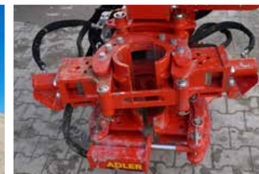
Lafettenfuß als Klemm-Brech-Hubschelle ausgeführt
