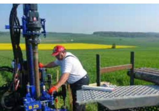
Borgerät B 25 im Einsatz beim Kerne ziehen
