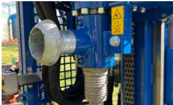
Kopfpreventer mit seitlichem Auslass
