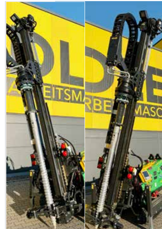
15° Mastneigung nach rechts / links, Overtilt 12°
