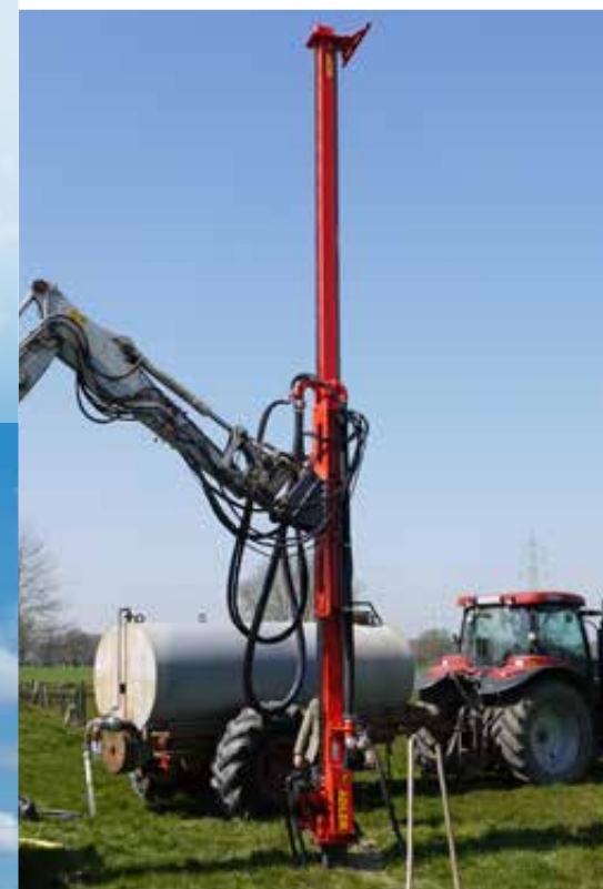
Anbaubohrlafette mit 6,5 m Verfahrweg am 8 t-Bagger
