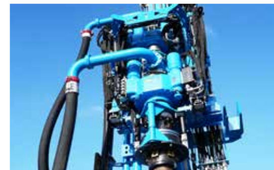
Doppelkopfbohrantrieb mit Spannglocke zum gleichzeitigen abteufen vom Bohrrohr und Außenverrohrung bei Überlagerungsbohrungen
