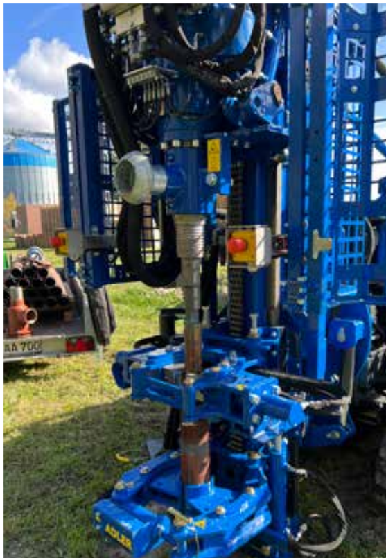
Klemm-Brech-Huschelle im Einsatz
