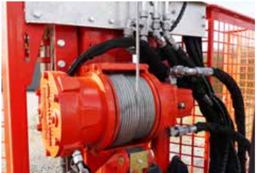
Seilwinde mit 5 kN (500 kg) Zugkraft
