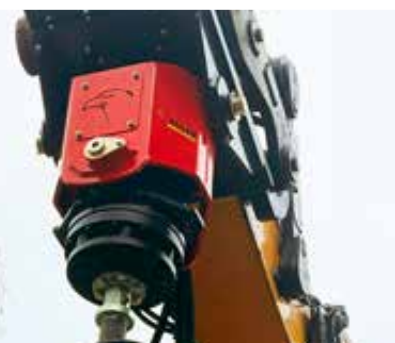
Kraftvoller Radialkolbenmotor mit hohem Wirkungsgrad ...
