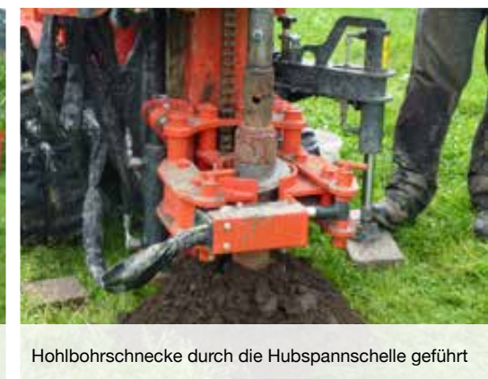
Einfaches Ausbauen der Hohlbohrschnecke durch schwenkbaren Bohrkopf
