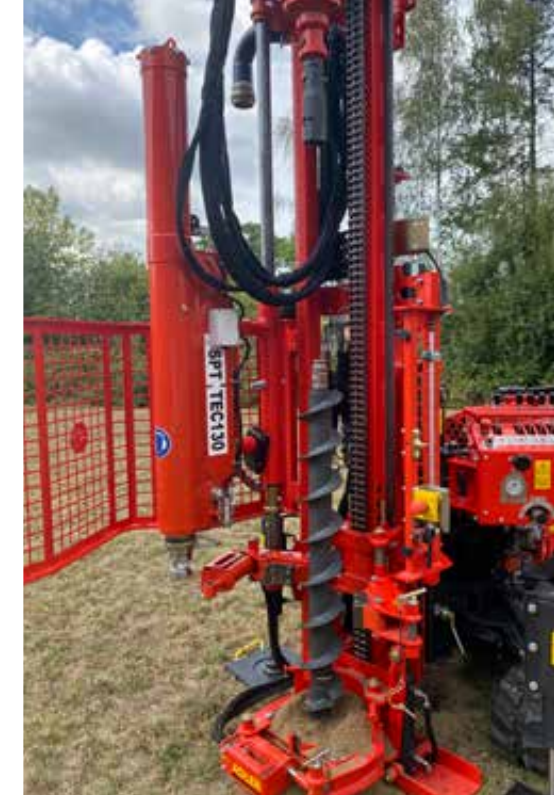
Sondierbohrung mit Hohlbohrschnecke oder Rammsondierung können im Wechsel durch Einschnwenken der Rammsondiereinheit durchgeführt werden
