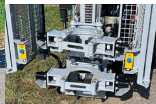
Klemmbrechhubschelle und untere Klemme
