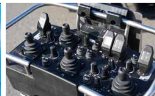
Ergonomische Fernbedienung für den kompletten Fahr- und Bohrbetrieb
