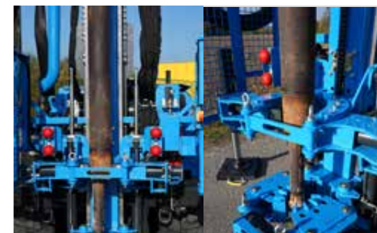
Klemmbrechhubschelle zum einfachen Brechen des Bohrgestänges und der Außenverrohrung mit Schutzrohrklemme unten
