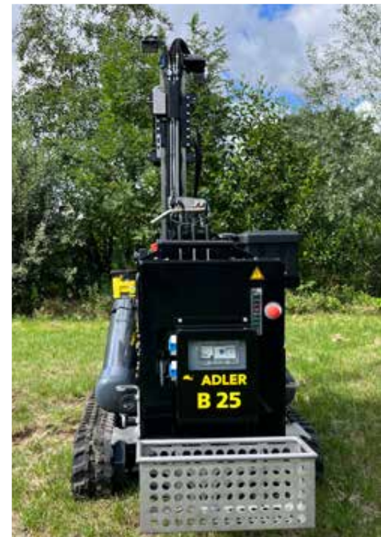
Ausgestattet mit Werkzeugkiste und Transportbehälter für Erdungsstangen
