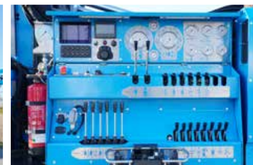
Steuerstand mit allen Instrumenten und Displays zur Überwachung des Bohrprozesses bzw. des Antriebsaggregates (Deutz-Motor)
