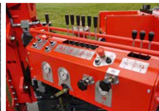
Ausschwenkbares Bedienpult zur Steuerung aller wichtigen Bohrfunktionen
