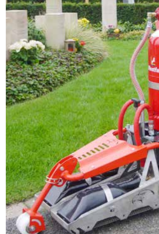
Door de voorste looprol worden de Infraroodstralers in optimale werkpositie geleid.
