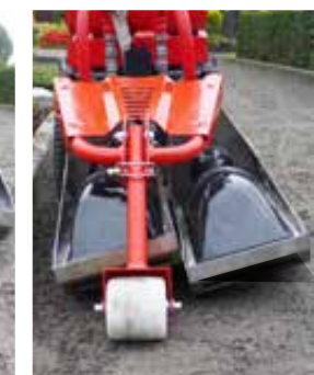
Ideaal om kanten te bewerken is de schuinverstelling van de stralers naar links of rechts
