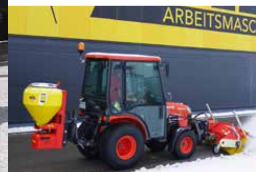
De K 560 aan het werk met een zoutstrooier ST-E winterdienst
