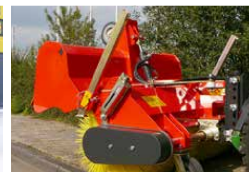
Toerental, draairichting en tandwielkast positie zijn variabel
