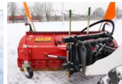
Universalaufnahme mit hydraulischer Verschwenkung (mit zwei Hydraulikzylindern)
