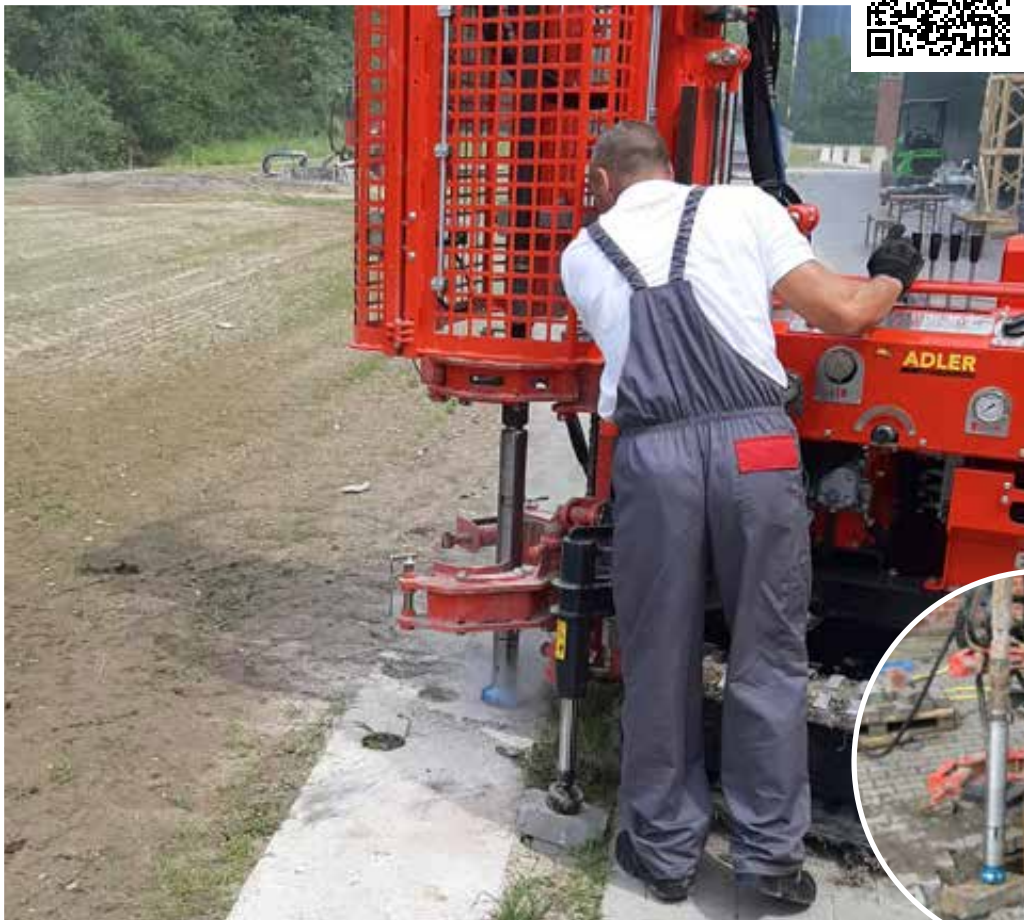
B 50 mit Imlochhammerausrüstung
