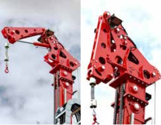
Hydraulischer klappbarer Mastausleger mit einer Hakenlast von 15 kN zum bequemen Zuführen des Bohrwerkzeuges
