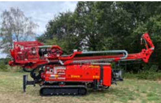
B 150 mit eingeklappter Bohrlafette im Verladezustand für den Transport zur Baustelle
