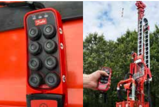
Zweite Funkfernbedienung für einfaches Handling der Seilwinde (optional)
