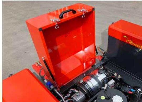
Öffnen der Regenschutzhube mithilfe von Gasdruckfedern
