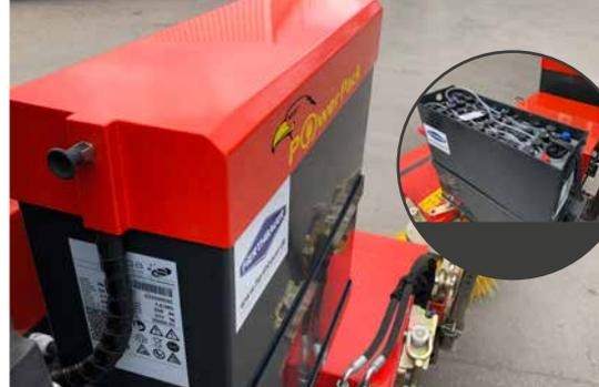
Marktübliche Blei-Gel-Akkus in verschiedenen Leistungsklassen und Baugrößen einsetzbar.
