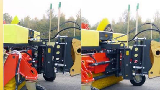
Alles ist immer dabei: Hydraulische Seitenverschwenkung, 3D-Niveaugleich, Höhenanzeiger und die innovative ADLER-Anbaukonsole.
