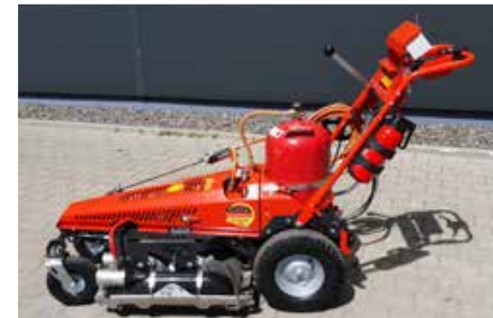
Große Antriebsräder und Differenzial-Getriebe sorgen für eine hohe Wendigkeit und leichtes Arbeiten
