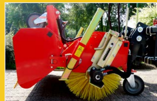
Frikopplingsläge, hydraulisk tömning av behållaren och tredje stödhjul vid uppsamlingsbehållaren
