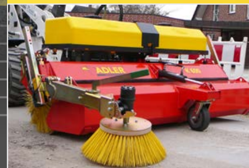
Sidoborste och vattenspolningsanordning som tillval
