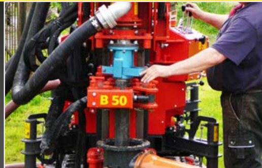
Skäranordning i samspel med hydraulisk klämma - Levereras som standard på alla modeller i B-serien
