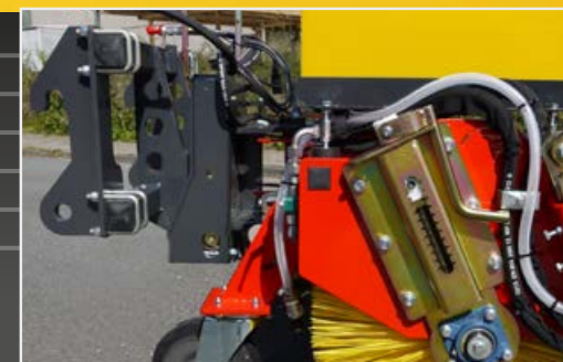
Montering vid hjullastare med nivåjustering via styrning med rullar
