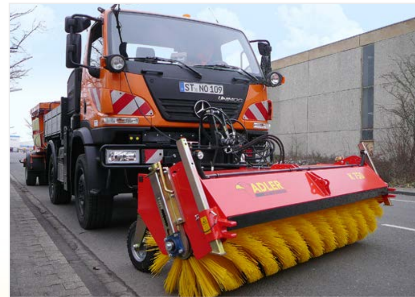
Kranarmsfäste med apparatlyftanordning enligt DIN 76060
