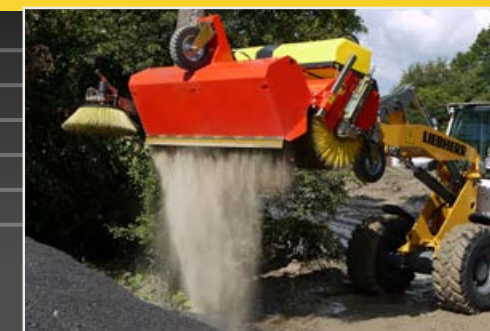
Hydraulisk tömning av smutsbehållaren
