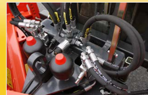
Elektrisk omkopplingsventil med överlastsäkring genom två tryckreduceringsventiler och kvävgasblåsa
