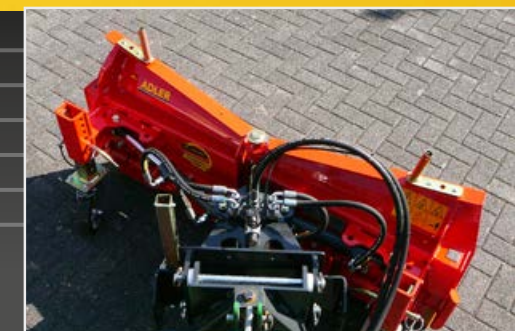
Montering på kompaktlastare med nivåjustering och parkeringsstöd
