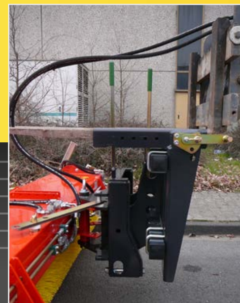
Montering på hjullastare via gaffelarmar med rullstyrning och 3D-utjämning
