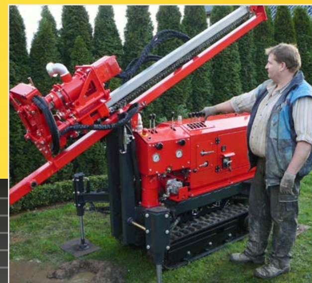
Fäll ut stödbenen och masten via hydraulik.
