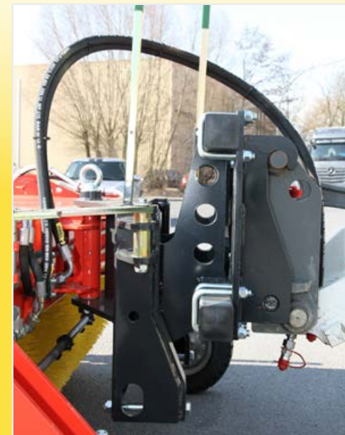
Montering vid hjullastare med rullstyrning och 3D-utjämning
