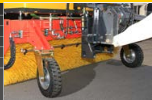
Tres grandes ruedas giratorias de 400 mm x 100 mm
