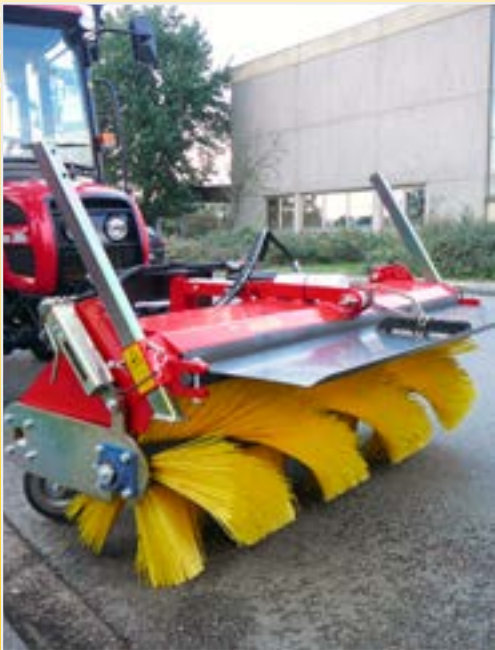
K 560 con chapa de protección contra salpicaduras ajustable
