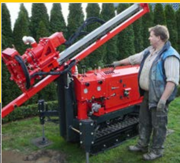
Desplegar los pies de apoyo y desplegar el mástil mediante el sistema hidráulico.
