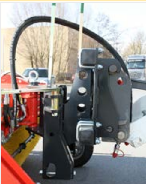
Fijación en cargadora de ruedas con sistema de rodillos y nivelación 3D
