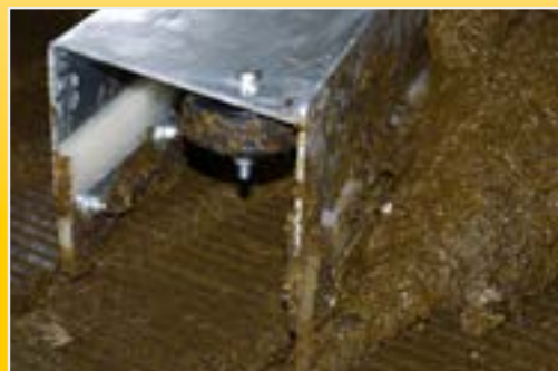
Raspador de doble reborde con rodillo espaciador
