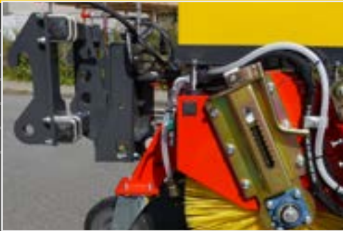
Fijación en cargadora con nivelación mediante sistema de rodillos
