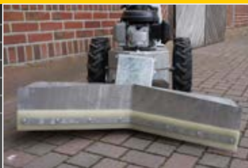
Raspador de la arrobadera con sistema de nivelación
