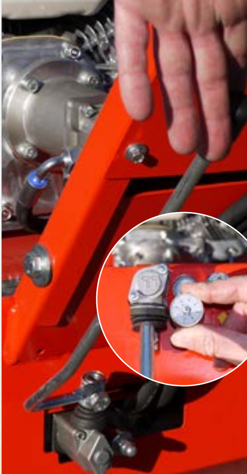
Dirección de palanca y transmisión de tracción ajustable de forma continua
