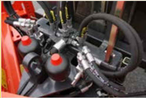
Válvula de conmutación eléctrica con protección contra sobrecarga mediante dos válvulas limitadoras de presión y acumulador de nitrógeno
