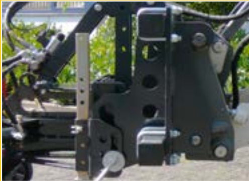
Fijación en cargadora compacta con sistema de nivelación y pie de apoyo
