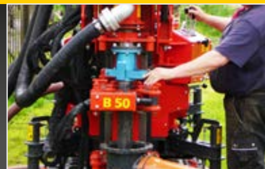
Dispositivo desenroscador en combinación con un retenedor hidráulico: de serie en todos los modelos de la serie B
