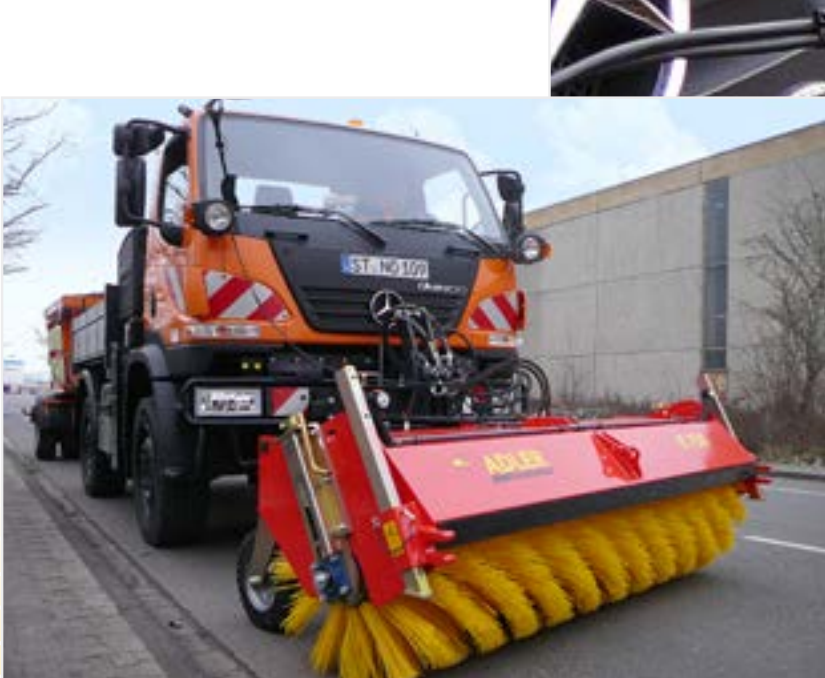
Fijación en Unimog con montaje según DIN 76060
