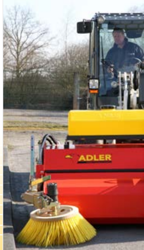
Cepillo de barrido lateral y depósito de agua de 240 l como opción
