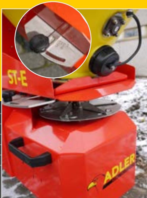
Anchuras de esparcido de hasta 8 m, ajustable mediante número de revoluciones y dosificación. Detalle: mecanismo de dosificación para ajustar la cantidad de sal
