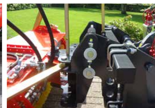
Attelage valets de fermes avec compensation de niveau 3D
