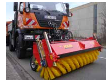
Attelage Unimog avec relevage de l'engin selon DIN 76060
