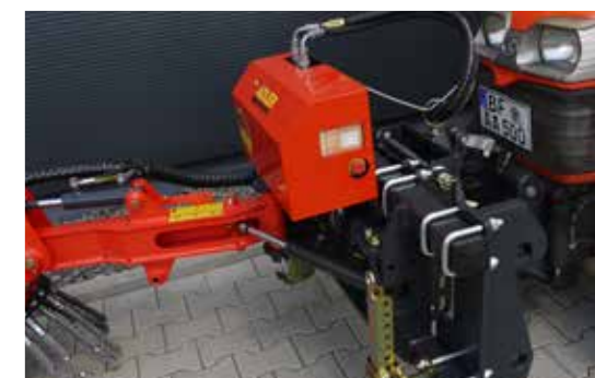
Attelage universel avec orientation latérale
