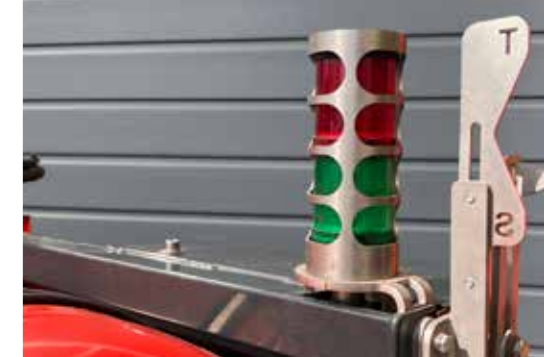
Indicateur de réglage de la hauteur et voyants de signalisation pour le contrôle du fonctionnement des émetteurs infrarouges
