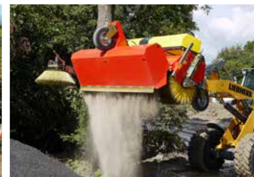
Vidange hydraulique du bac collecteur des déchets
