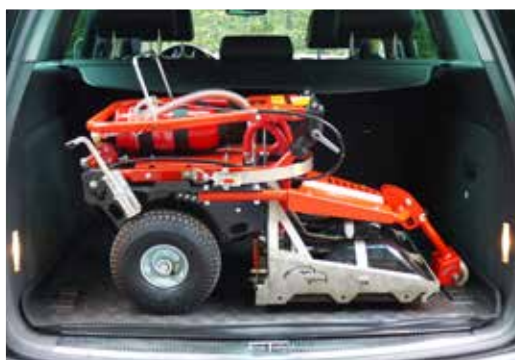
Le Flexi est facilement pliable et peut être transporté – par sa construction compacte – pratiquement dans n'importe quel coffre de voiture.
