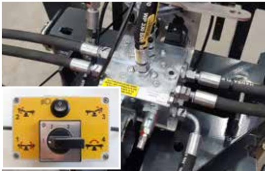
Vanne de commutation électrique + sécurité contre les surcharges = Commande confort
