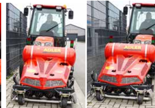
Décalage latéral hydraulique de 20 cm à droite et à gauche
