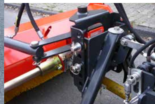
Système d'attelage Triangle d'attelage CAT Communal
