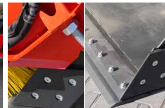
Lame d'usure échangeable en bas et sur le côté
