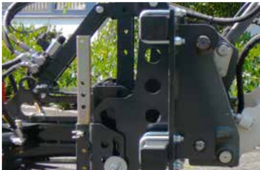
Attelage valets de fermes avec compensation de niveau et béquille de support.
