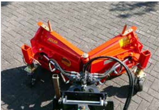
Toutes les possibilités de déneigement en position V, Y et diagonale
