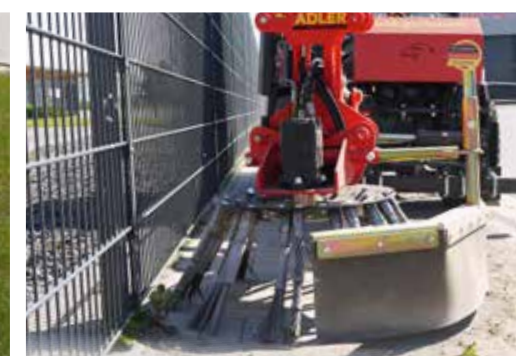
Bras pivotant (mécanique / hydraulique) pour le traitement de grandes surfaces
