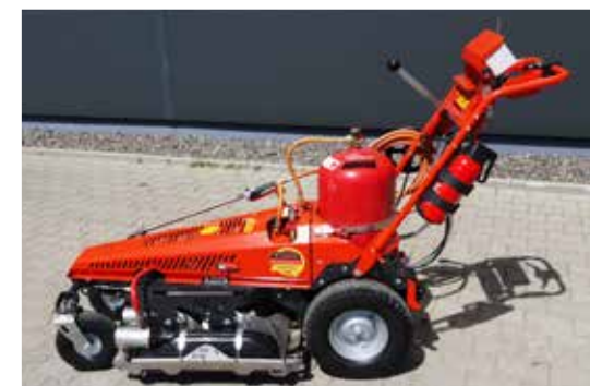
Grandes roues motrices et un réducteur différentiel assurent une grande maniabilité et facilitent le travail
