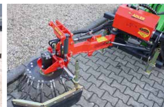
Inclinaison longitudinale et transversale à réglage hydraulique ou mécanique
