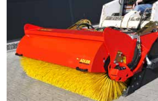
Clapet de protection anti-poussière réglable
