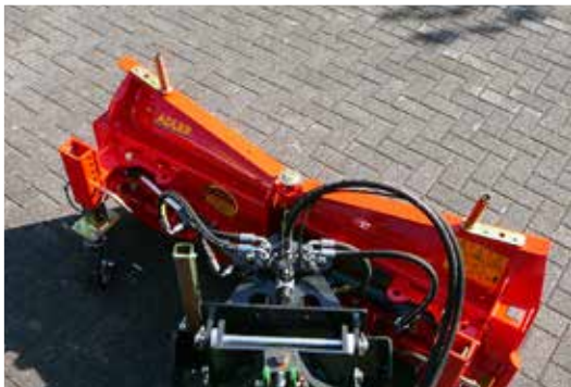
Attelage valets de fermes avec compensation de niveau et béquille de support.
