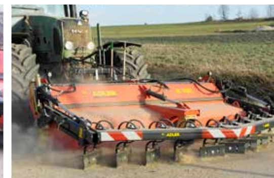
Combinaison avec bac collecteur pour la Balayeuse K 750 jusqu'à 270 cm
