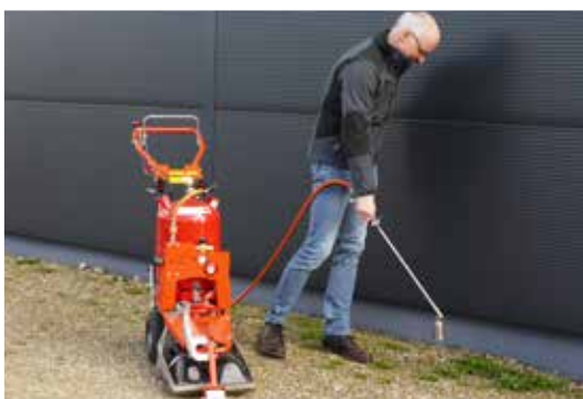
Avec le brûleur à main vous pouvez également travailler dans les endroits d'accès difficiles.
