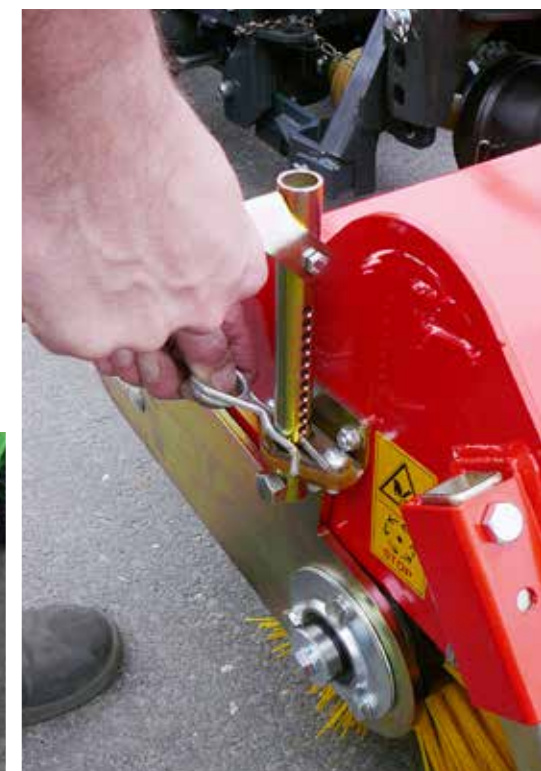
Réglage des brosses par système d'enfichage
