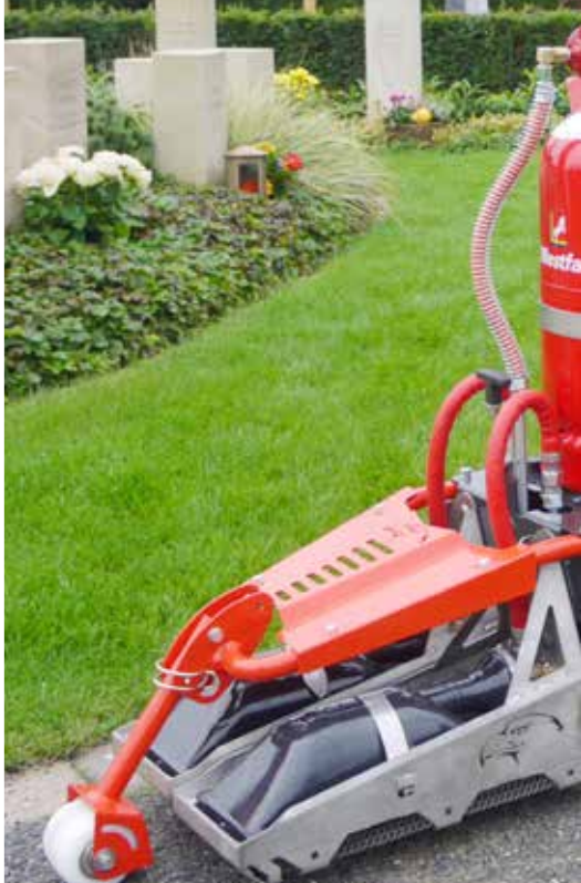
Par la roue avant les lampes infrarouges sont guidés à l'hauteur optimale de travail
