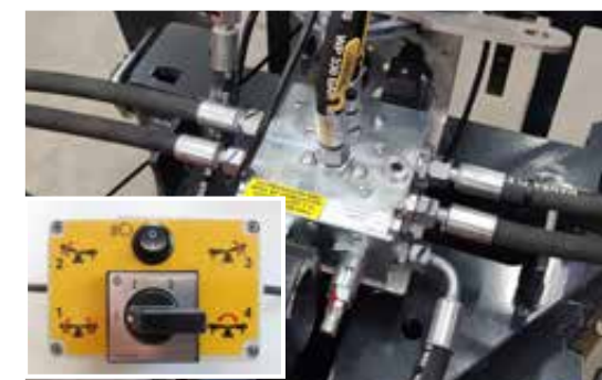
Elektrisches Umschaltventil + Überlastsicherung = Komfort-Steuerung
