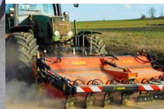
K 750 mit Kratzvorrichtung und Schmutzsammelbehälter
