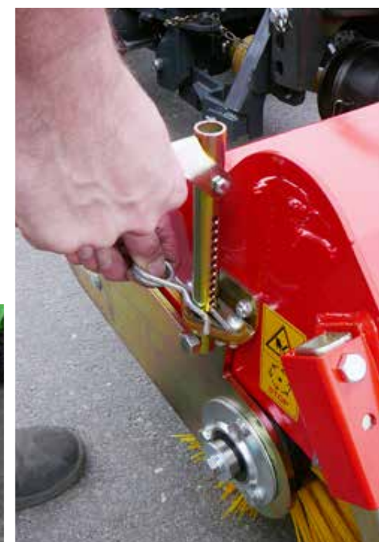
Bürstenverstellung über Stecksystem
