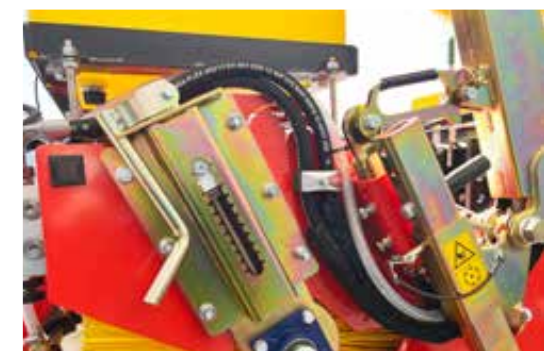
Bürste stufenlos einstellbar
