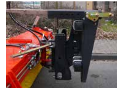
Radladeraufnahme Gabelzinken mit Rollenföhrung und 3D-Ausgleich
