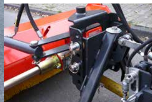
Aufnahmesystem Kuppeldreieck KAT Kommunal
