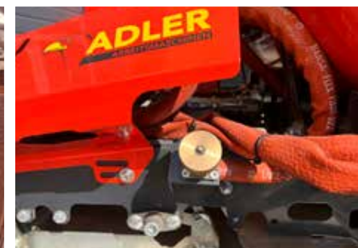
Seitlicher Füllstutzen für LPG-Autogas
