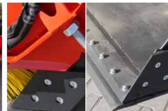
Wechselbare Verschleißmesser unten und seitlich
