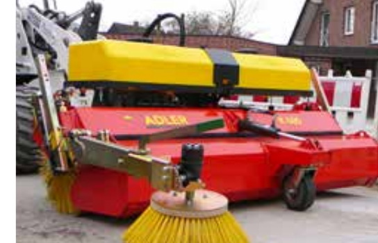
Seitenkehrbesen und Wassersprüheinrichtung als Option
