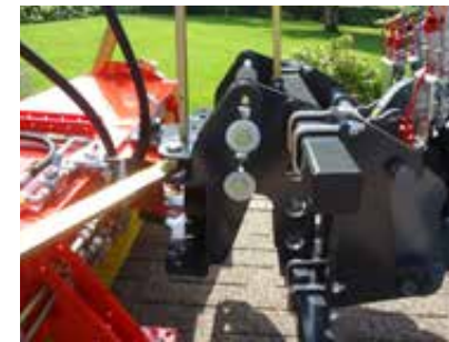
Hofladeraufnahme mit Langlochsystem und 3D-Ausgleich
