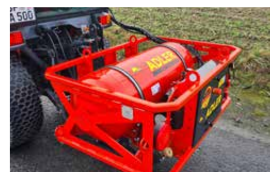
Hecktankträger für 80 l und 120 l Gastanks
