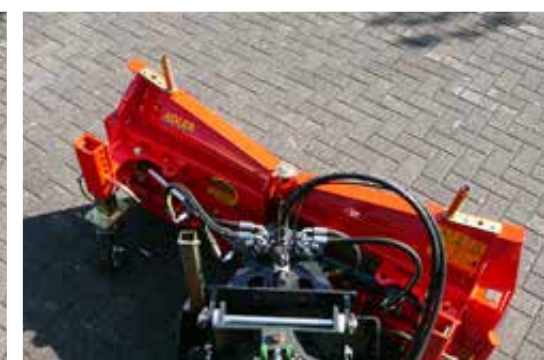
Hofladeraufnahme mit Niveaueingleich und Abstellstütze
