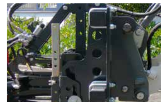
Hofladeraufnahme mit Niveaueingleich und Abstellstütze
