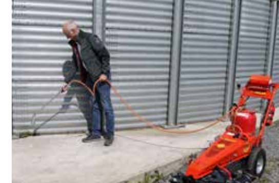
Handbrenner für schwer erreichbare Ecken und Kanten
