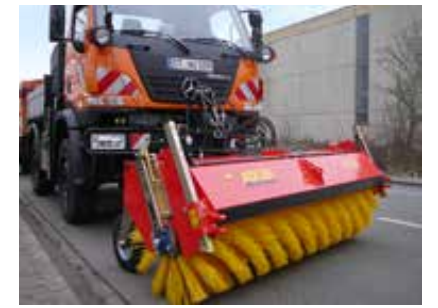
Unimogaufnahme mit Geräteaushebung nach DIN 76060
