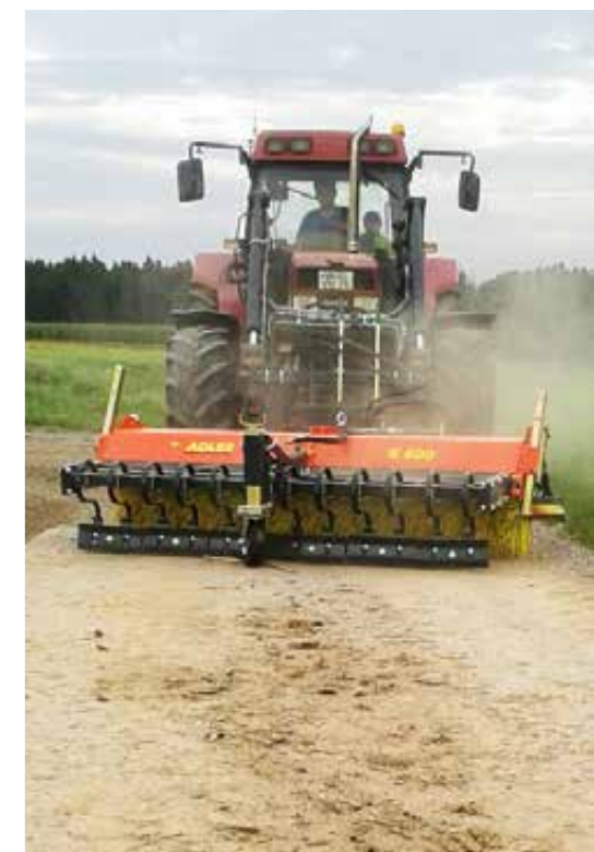
Kratzvorrichtung KV-Serie mit 3. Stützrad
