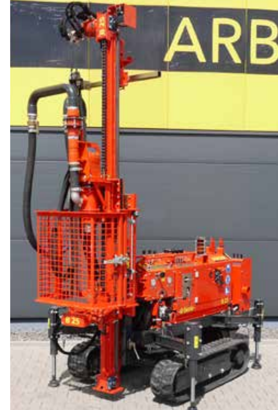
ADLER-Bohrgerät auf ADLER-Raupenfahrwerk
