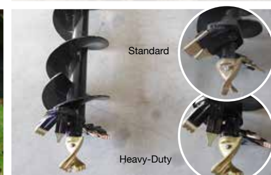
Bohrschnecken und verschiedene Qualitäten in Standard- und Heavy-Duty-Ausführung
