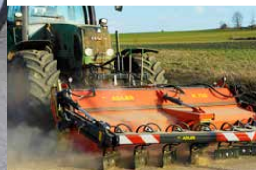
K 750 mit Kratzvorrichtung und Schmutzsammelbehälter
