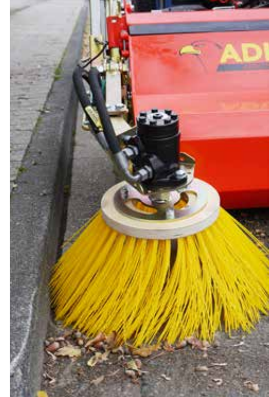
Seitenkehrbesen im Einsatz
