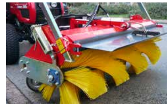
K 560 mit verstellbarem Spritzschutzblech
