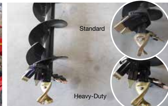
Bohrschnecken in verschiedenen Qualitäten: Standard und Heavy-Duty-Ausführung
