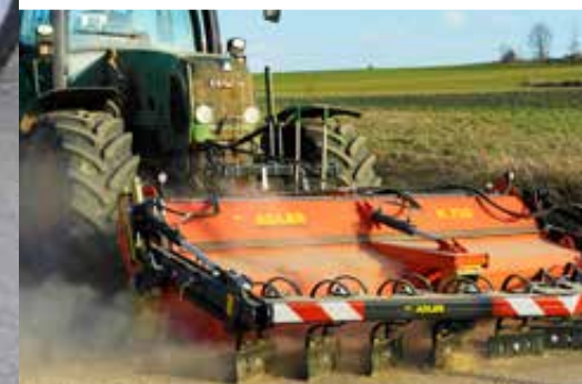
K 750 mit Kratzvorrichtung und Schmutzsammelbehälter
