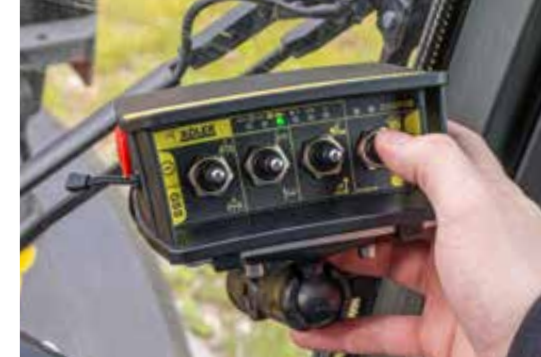
Funkfernbedienung für die bequeme Steuerung in der Kabine
