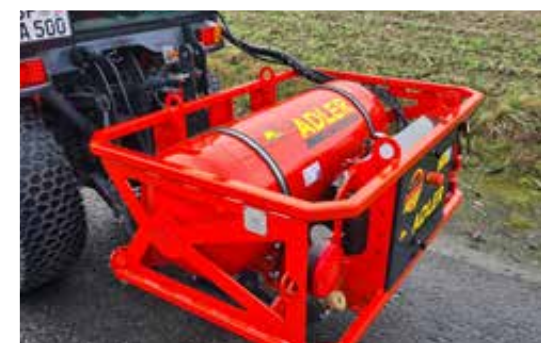
Hecktankträger für 80 l und 120 l Gastanks
