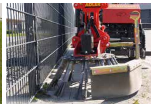
Mechanischer oder hydraulischer Schwenkarm zur Bearbeitung großer Flächen
