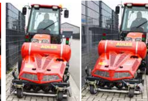
Hydraulische Seitenverschiebung um jeweils 20 cm nach rechts und links
