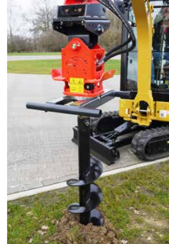
Erdbohrer E 100 mit Ø 250er Bohrspindel
