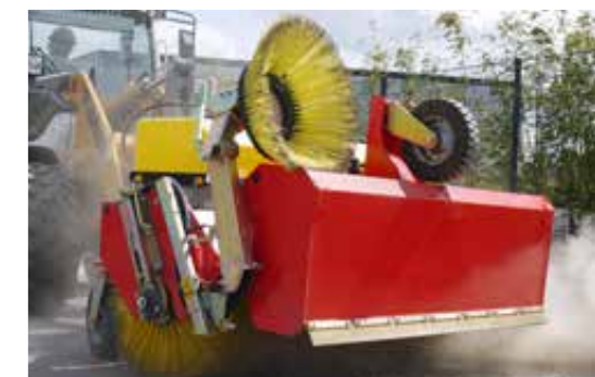
Freikehrmodus und 750 mm Bürstendurchmesser serienmäßig
