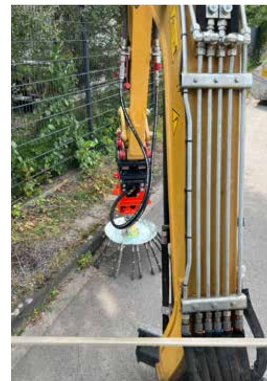
Optimale Sicht aus der Kabine auf die Baggerwildkrautbürste BW 800
