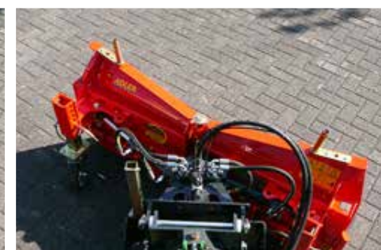
Universalaufnahme mit Niveaue Ausgleich und Abstellstütze
