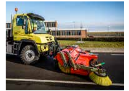
Unimogaufnahme mit Geräteaushebung nach GröÖe 3/5
