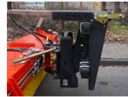
Radladeraufnahme Gabelzinken mit Rollenföhrung und 3D-Ausgleich
