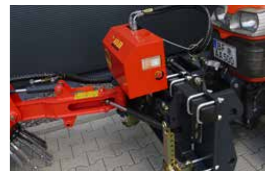
Universalanbau mit Seitenausschwenkung
