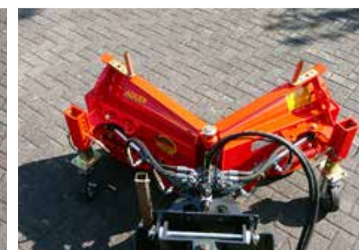
Alle Räummöglichkeiten in V-, Y- und Diagonalstellung
