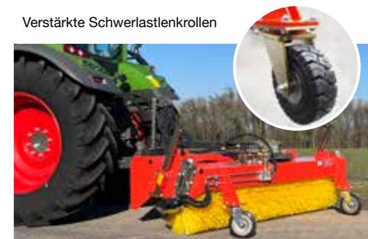
Dreipunktanschluss für Heck- und Frontanbau
