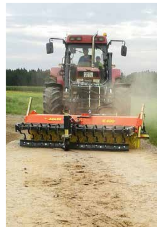
Kratzvorrichtung KV-Serie mit 3. Stützrad
