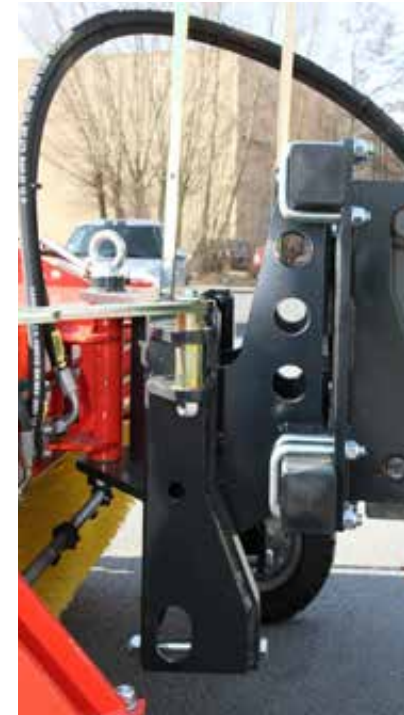
Schwere Universalaufnahme mit Rollenschachtsystem und 3D-Niveauausgleich
