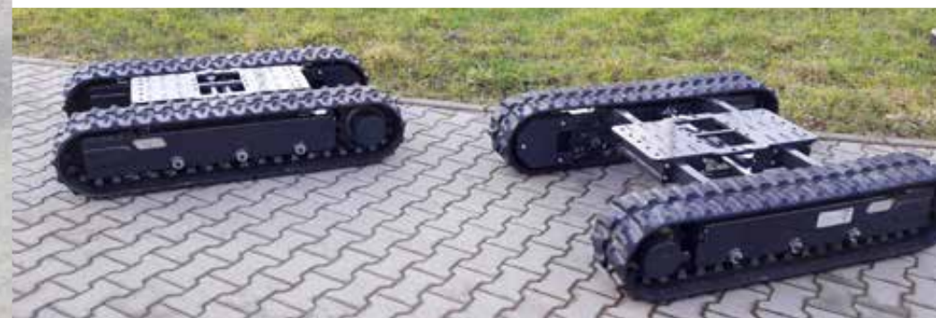
Die Fahrwerke können wahlweise hydraulisch teleskopierbar oder ohne Mittelteil gefertigt werden.
