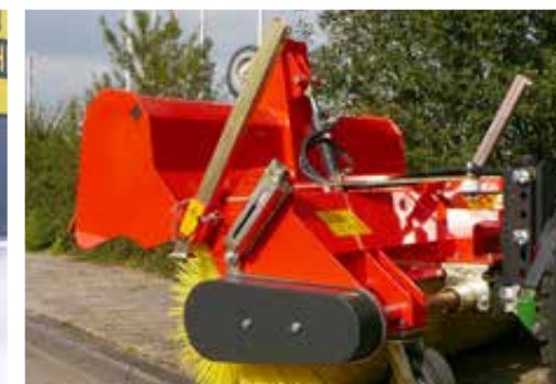
Optional: Schmutzsammelbehälter mit Freikehrmodus
