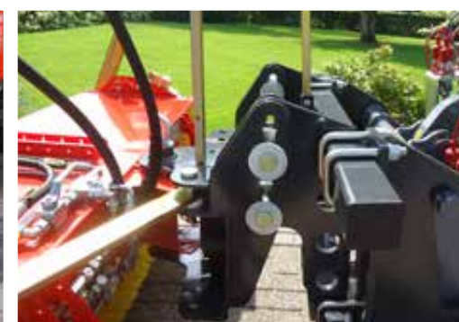
Universalaufnahme mit 3D-Niveaueingleich
