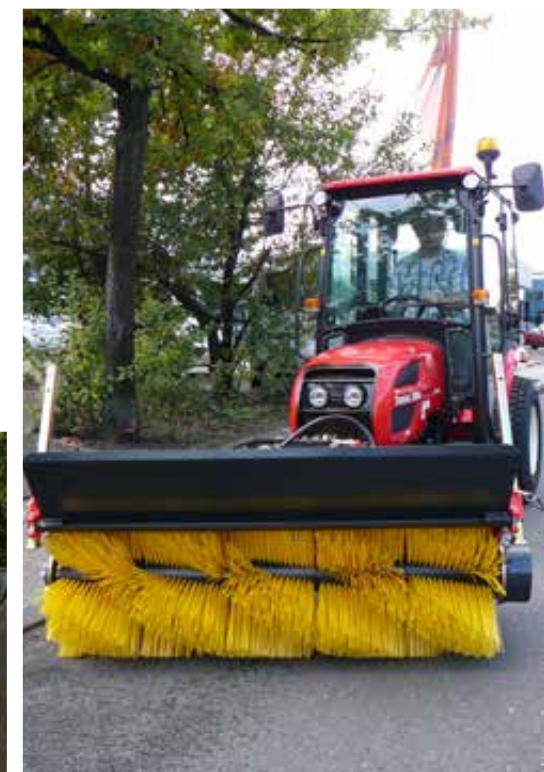
Großer Auswurfwinkel im Maschinenrahmen – ideal zum Schneekehren
