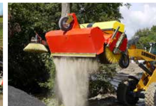
Hydraulische Entleerung des Sammelbehälters
