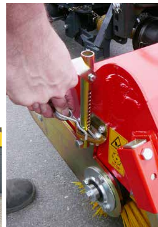
Bürstenverstellung über Stecksystem
