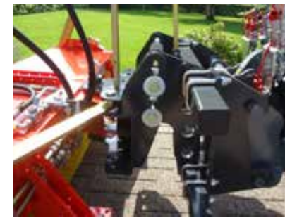
Hofladeraufnahme mit Langlochsystem und 3D-Ausgleich
