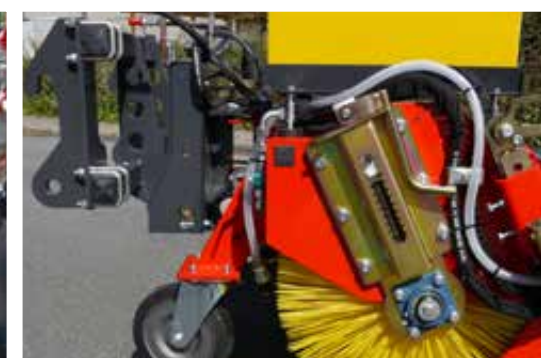
Schwere Universalaufnahme mit 3D-Niveaueingleich über Rollenführung
