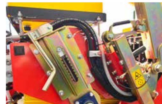
Bürste stufenlos einstellbar
