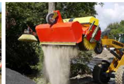
Hydraulische Entleerung des Sammelbehälters
