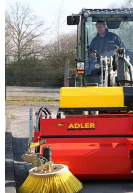
Seitenkehrbesen und Wassertank 240 l als Option
