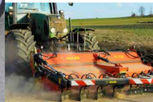
K 750 mit Kratzvorrichtung und Schmutzsammelbehälter
