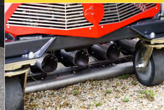
Мощные опорные ролики одновременно закрывают систему Infrabox от механических воздействий
