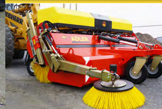
Гидравлически складываемая и подключаемая боковая лотковая щетка (Ø 900 мм).
