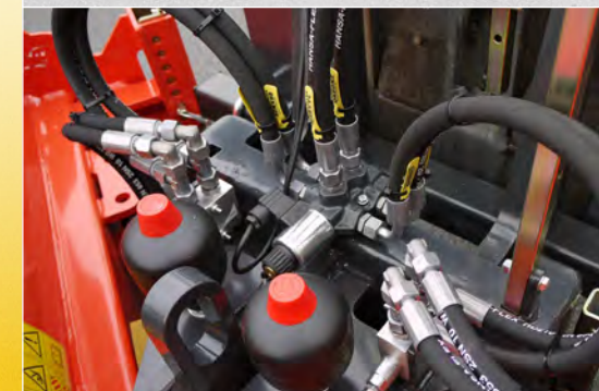
Демпфер и электрический защитный клапан
