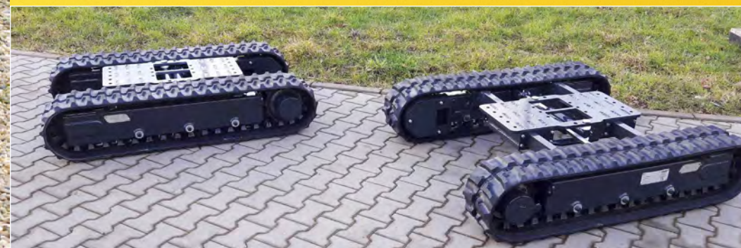
Гусеничный шасси могут быть либо жесткими, либо раздвижными с гидравлическим приводом.
