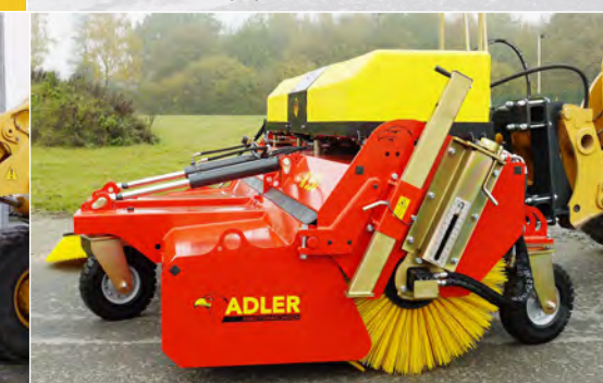
Четыре опорных колеса (460 мм x 125 мм) обеспечивают отличную стабильность при работе.
