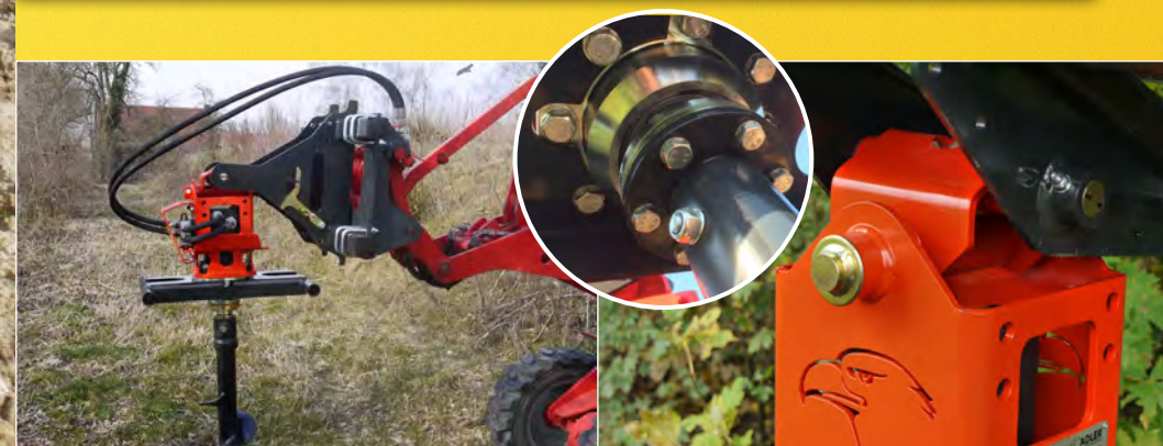
Универсальный шарнир и редуктор в стандартной комплектации
