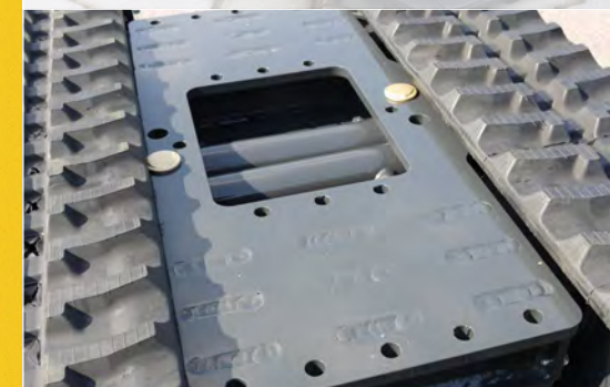
Центральная часть шасси имеет множество винтовых точек монтажа, которые можно использовать по своему усмотрению.
