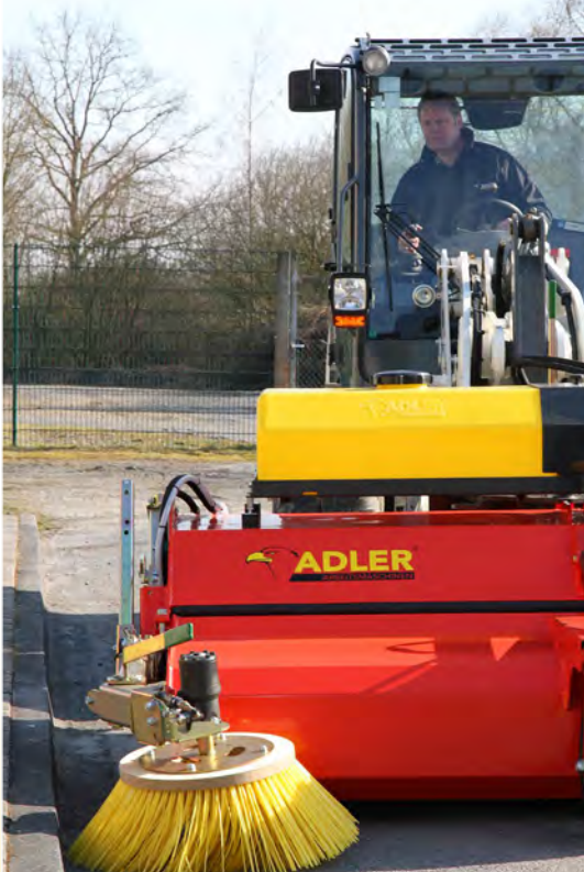
Боковая лотковая щетка и бак увлажнителя на 240 литров.
