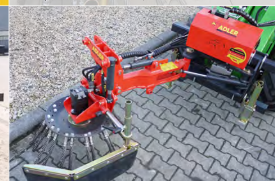
Гидравлически регулируемый продольный и поперечный наклон, опционально механически
