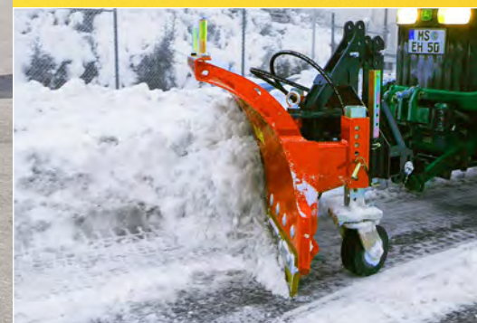
Снежный отвал толщиной 5 или 6 мм
