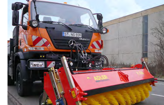
Система крепежа в соответствии по DIN 76060 на примере машины Unimog
