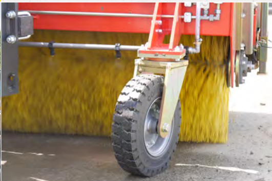
Три опорных колеса 400 мм x 100 мм
