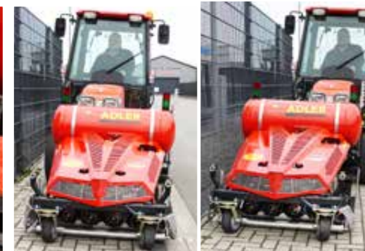
Hydraulische Seitenverschiebung um jeweils 20 cm nach rechts und links
