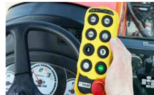
Funkfernbedienung mit Saugnapfhalterung und Notaus
