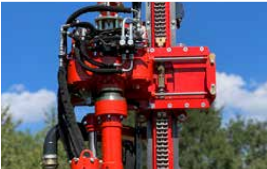
Seitenverschiebung Bohrkopf bei B 25
