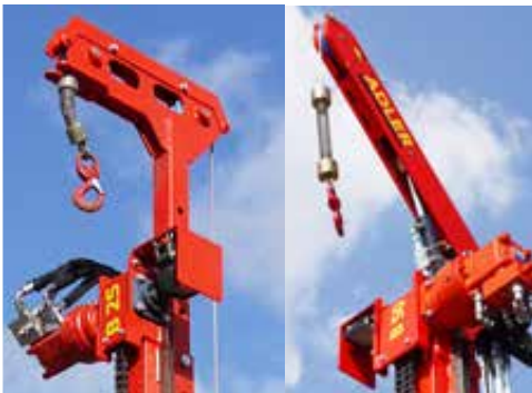
Mastausleger starr oder hydraulisch für die Seilumlenkung
