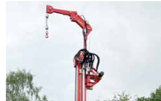
Seilwinde mit Seilschlageinrichtung und Mastverlängerung
