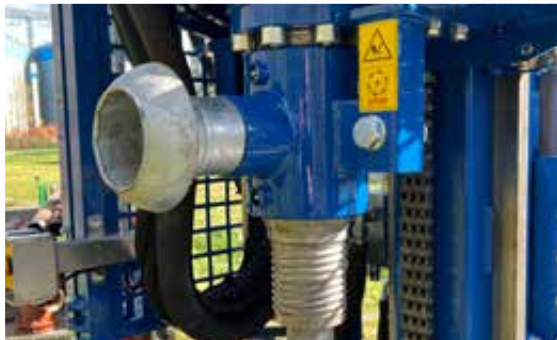
Kopfpreventer mit seitlichem Auslass
