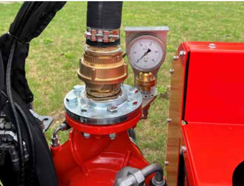
Spülpumpe mit Spüldruckanzeige
