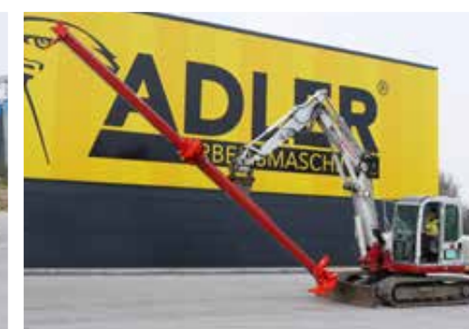
Anbaubohrlafette im Bohrprozess am Bagger
