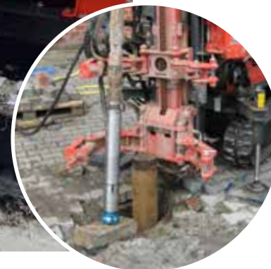
3" Imlochhammer mit Bohrkronen
