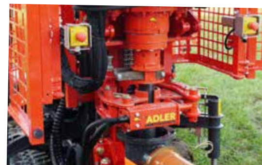
Hubspannschelle und hydraulische Gestängebrechklemme </div> <div data-bbox="830 935 905 950" data-label="Caption"> <p>Spülpumpe "on board"</p> </div> <div data-bbox="496 770 661 929" data-label="Image"> <img alt="Close-up of the control panel for the drilling rig."/> </div> <div data-bbox="522 929 634 955" data-label="Caption"> <p>Übersichtliche Bedienungseinheit zur Steuerung des Bohrgerätes</p> </div> <div data-bbox="666 770 826 929" data-label="Image"> <img alt="Close-up of the 2-stage drilling drive mechanism."/> </div> <div data-bbox="668 932 813 957" data-label="Caption"> <p>2-stufiger Bohrantrieb mit Drehmomenten bis zu 620 daNm oder Umdrehungen bis zu 210 U/min</p> </div> </div>
