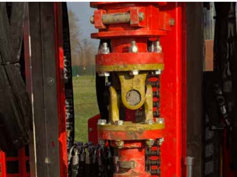
Kreuzgelenk mit BOM 73,5 oben, SW 41/51 unten
