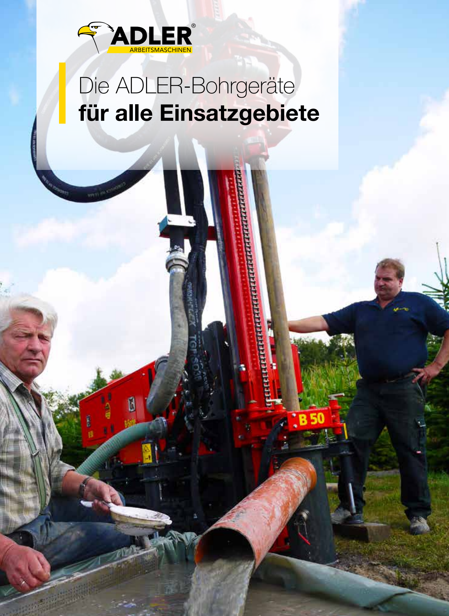
Entnahme von Materialproben aus dem Spülbohrwasser
