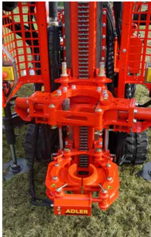
Klemm-Brech-Hubspannschelle
