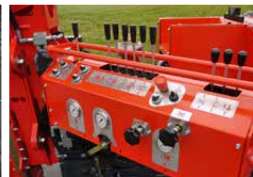
Ausschwenkbare Bedienpult zur Steuerung aller wichtigen Bohrfunktionen
