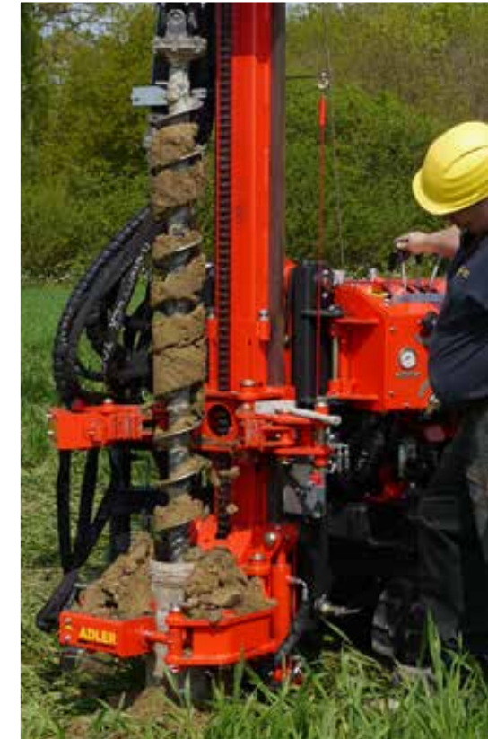
Einfache Ansteuerung der Bohrschnecke über den Steuerstand
