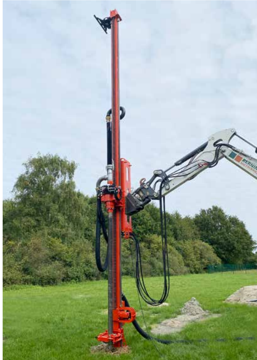
Spülbohren mit einem Wasserkreislauf
