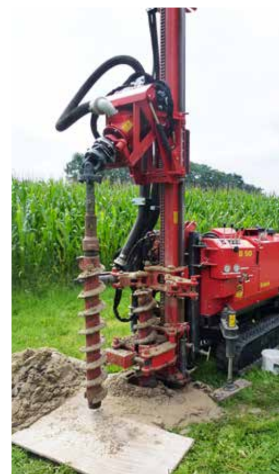
Einfaches Ausbauen der Hohlbohrschnecke durch schwenkbaren Bohrkopf
