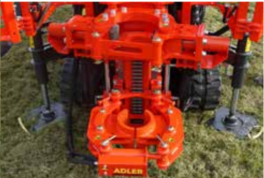
Klemm-Brech-Hubschelle bis 11,8 Tonnen Zugkraft
