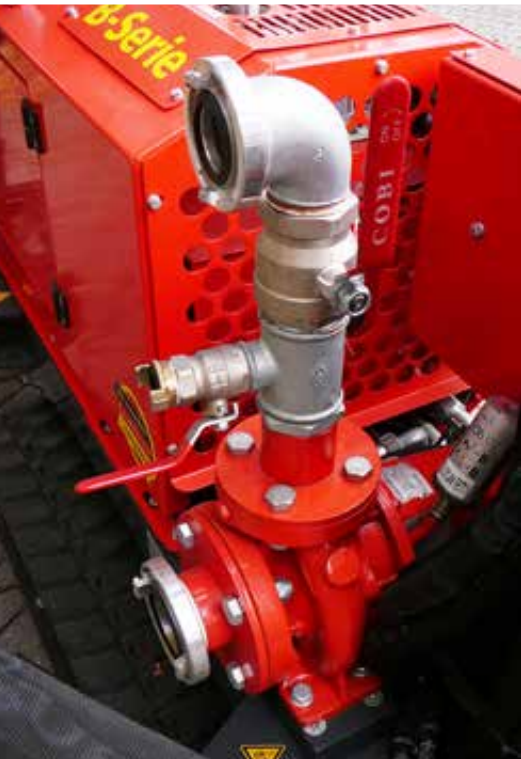
Die Spülpumpe kann auf Wunsch in das Bohrgerät B 15 integriert werden
