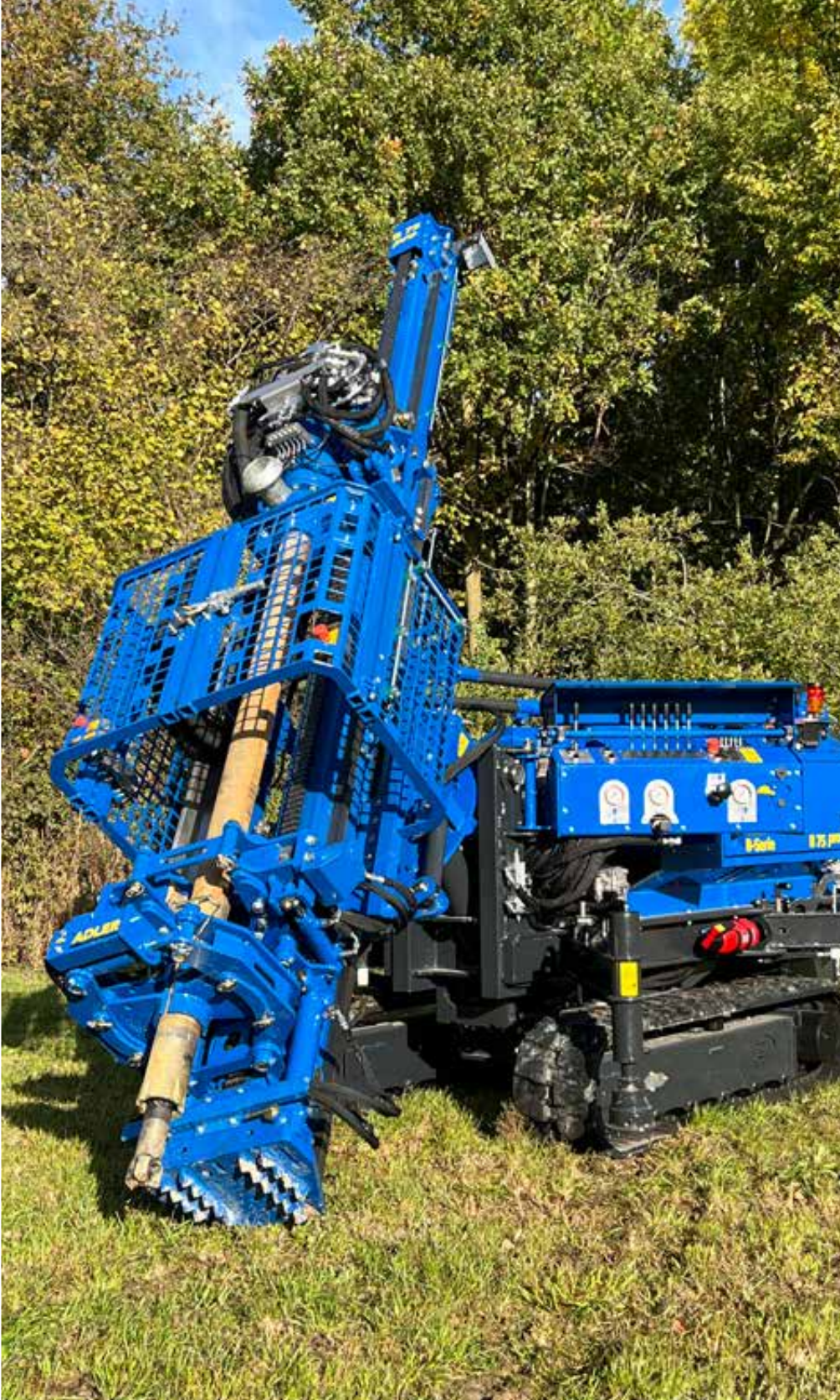
B 75 mit 3D Schrägeinrichtung inkl. zwei Mastabstützungen
