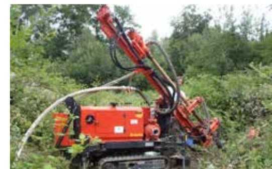
B 25 mit Schrägbohrereinrichtung
