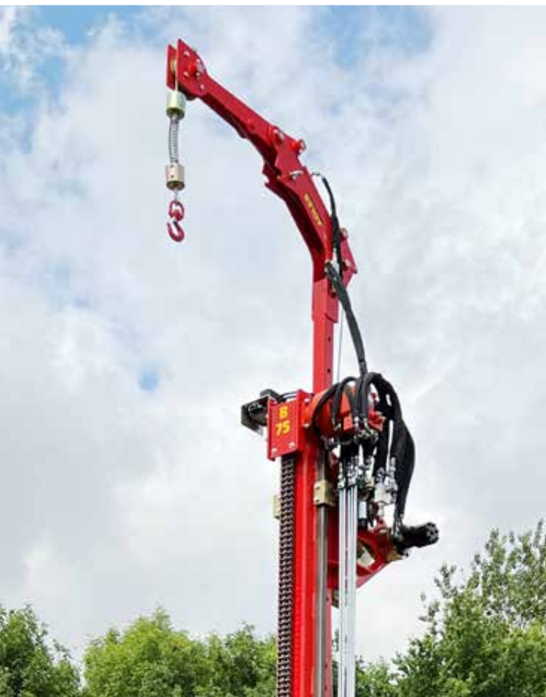
Hydraulischer Mastausleger mit Seilschlageinrichtung
