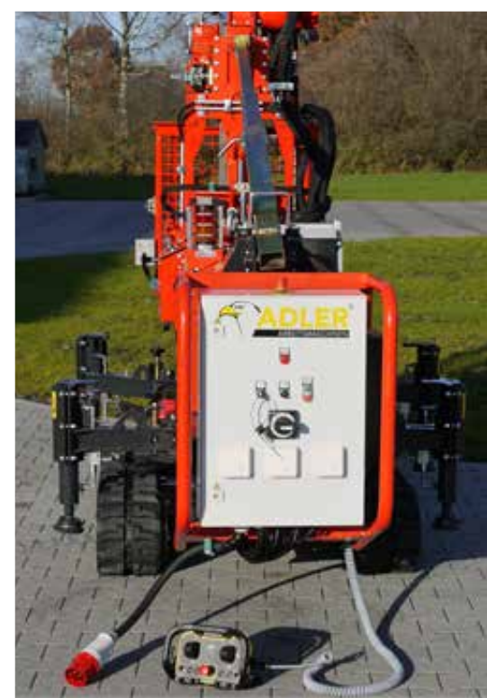
Elektroschaltschrank mit drei CEE Steckdosen (Ausgang)
