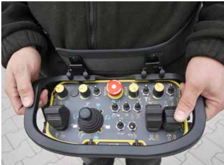
Fernbedienung für Fahren und Bohren (optional)
