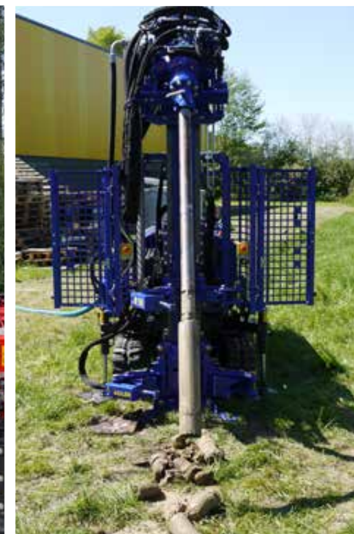
Kernbohrungen mit einem Einfachkernrohr oder mit Doppelkernrohr
