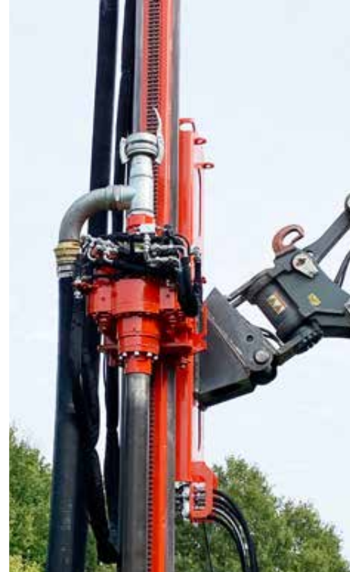
ADLER-Getriebebohrkopf mit Einlass für Filterrohre
