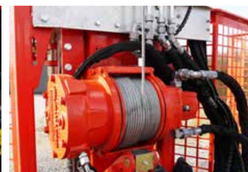
Seilwinde mit 5 kN (500 kg) Zugkraft
