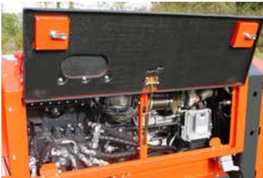
Bohrgerät B 75 ausgestattet mit 75 PS und 2,9 Liter Deutz-Motor der neuesten Abgasstufe 5
