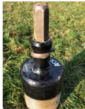
Einbau- und Hebekappe für die Aussenverrohrung
