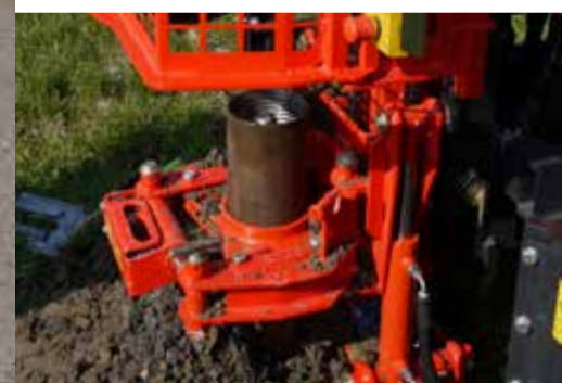
Optional beim B 25: Hubspannschelle für verrohrtes Bohren
