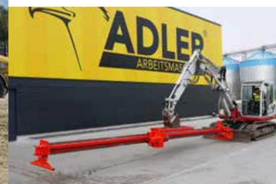
Aufstellen der Bohrlafette ABL mit dem Bagger
