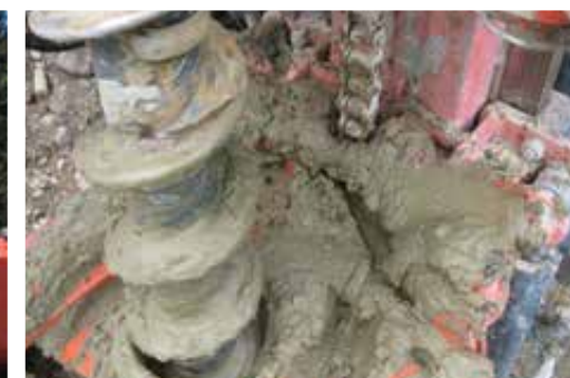
Förderung des Bohrgutes mittels Schnecke
