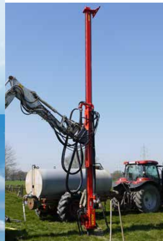
Anbaubohrlafette mit 6,5 m Verfahrweg am 8 t-Bagger
