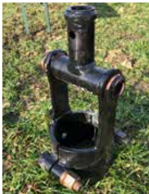
Ausbauklammer für die Aussenverrohrung
