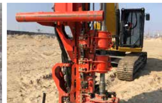
Klemm-Brech-Hubschelle im Einsatz
