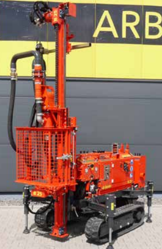
ADLER-Bohrgerät auf ADLER-Raupenfahrwerk
