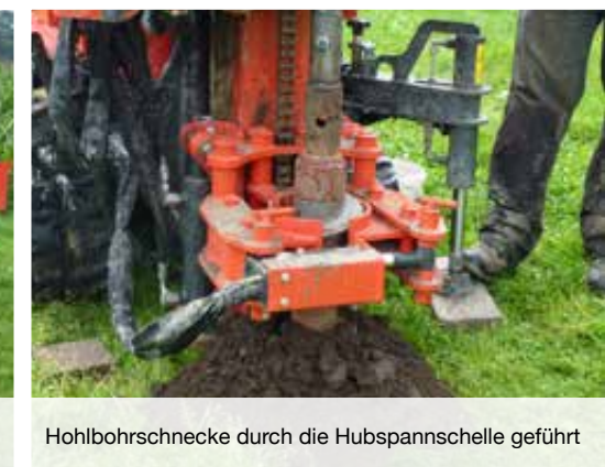
Einfaches Ausbauen der Hohlbohrschnecke durch schwenkbaren Bohrkopf
