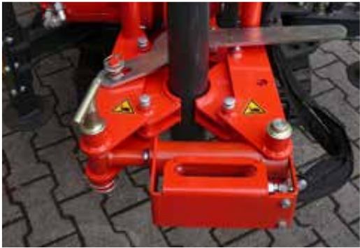
Hydraulische Gestängebrechvorrichtung
