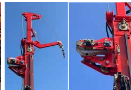
Mastkrone mit Seilschlageinrichtung
