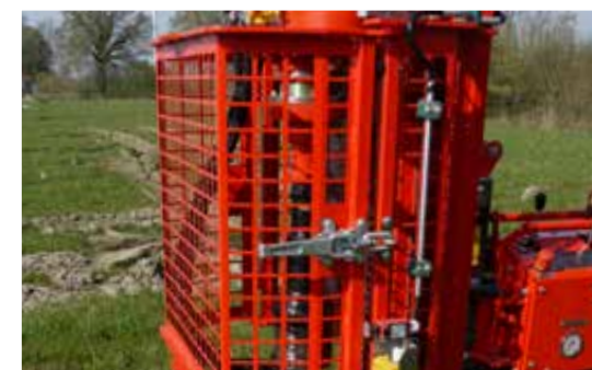
Schutteinrichtung im Bereich des drehenden Gestänges serienmäßig
