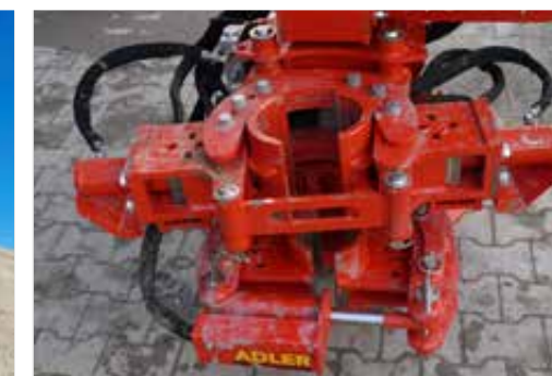
Lafettenfuß als Klemm-Brech-Hubschelle ausgeführt
