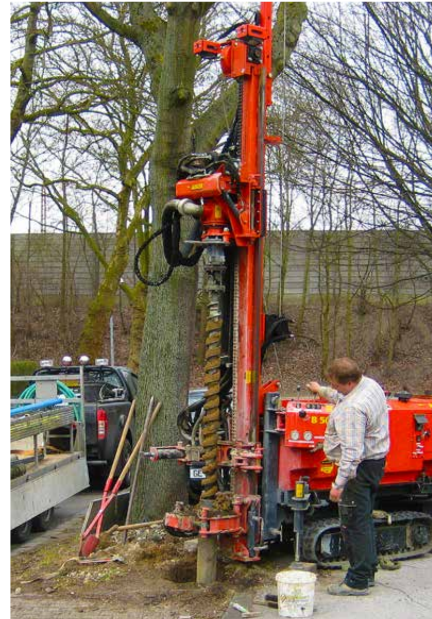
B 50 mit Trockenbohrrausrüstung ist aufgrund seiner kompakten Bauform auch in beengten Verhältnissen einsetzbar
