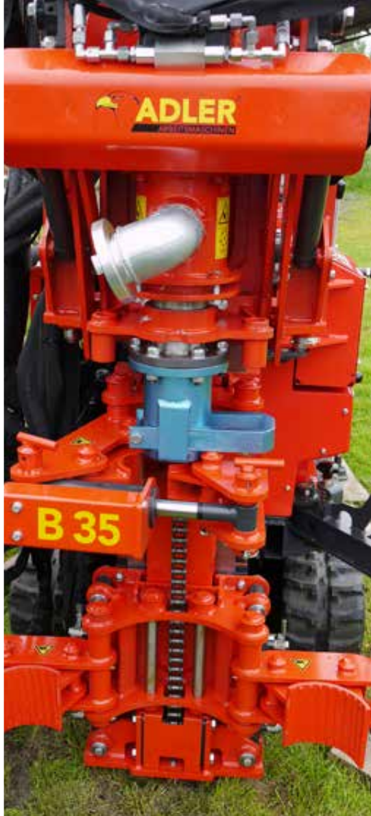
Spülbohrkopf, Brechvorrichtung, hydraulische Klemme und Hubspannschelle
