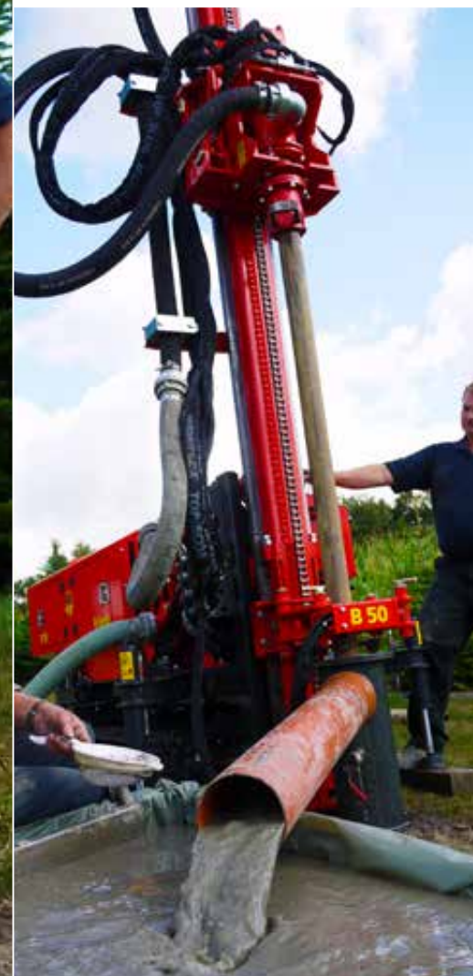
Entnahme von Materialproben aus dem Spülbohrwasser
