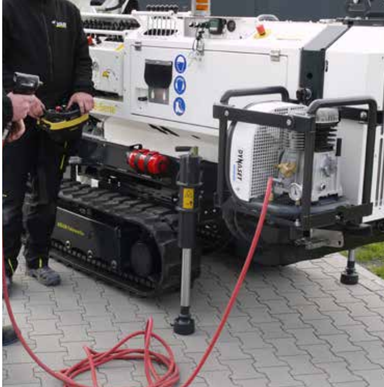
Luftkompressor – Antrieb über das Bohrgerät
