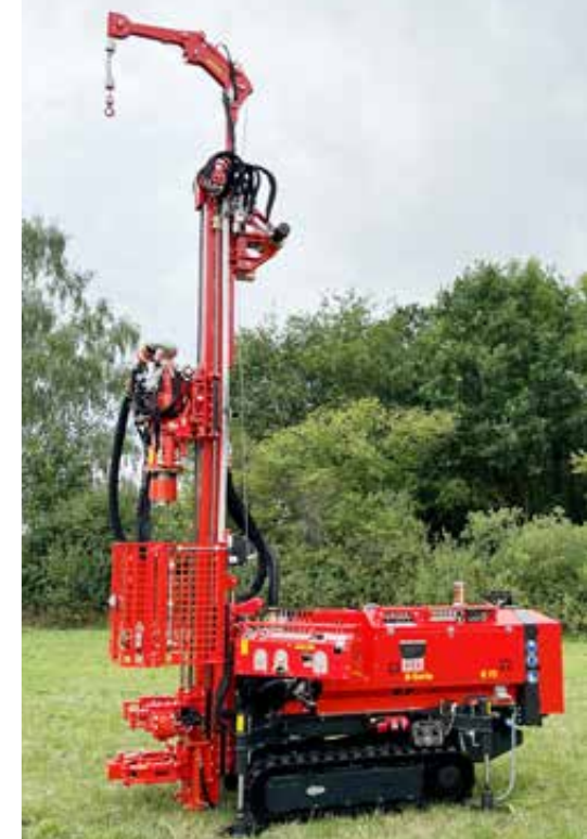
Ausschwenkbarer Getriebebohrkopf mit durchgehender 2 1/2" Spülwelle
