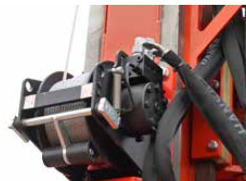
Seilwinde mit 500 kg oder 1.000 kg Zugkraft
