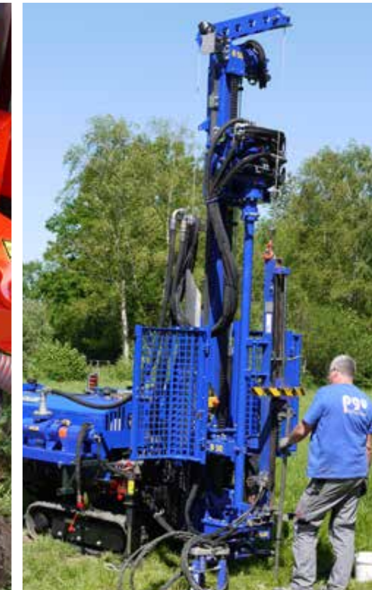
Rammsondieren mit dem ADLER-Borgerät B 50
