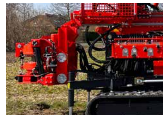
Verrohrungsdrehtisch in Transportstellung
