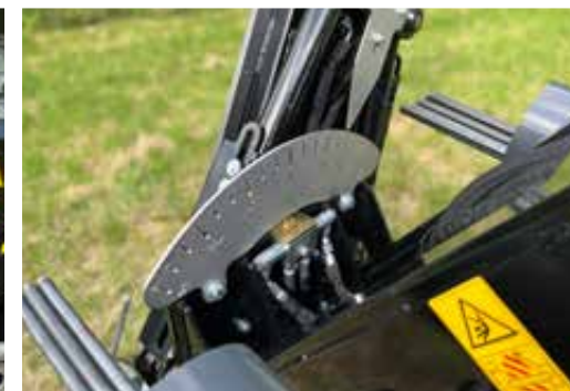
Winkelmeßeinheit für schräges Schlagen
