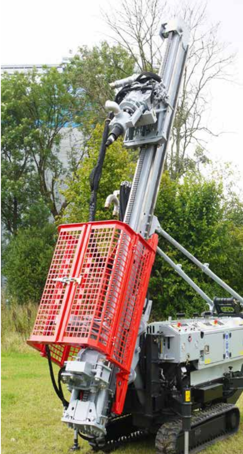
Schrägbohrereinrichtung mit Lafettenstützen
