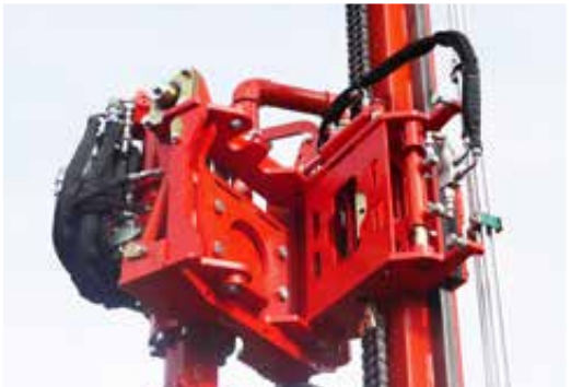
Hydraulische Verschwenkung des Bohrkopfes aus dem Bohrzentrum
