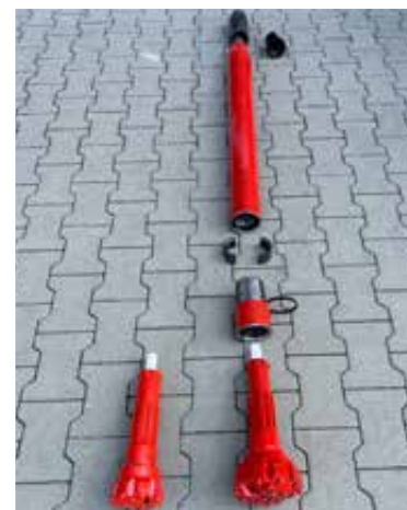
Imlochhammer mit verschiedenen Bohrkronen
