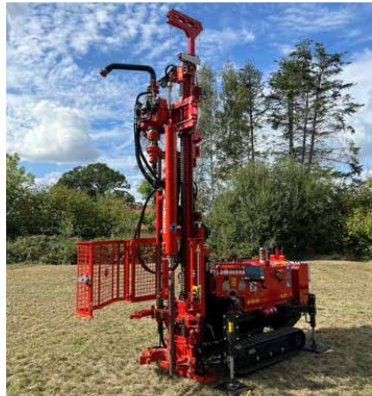
B 25 ausgerüstet mit Rammsondiereinheit
