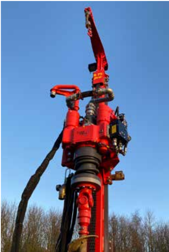
Getriebebohrkopf mit Floatingspindel am B 75 pro
