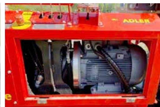
Emissionfreudlicher Elektromotor 18,5 kW – 380 V – 3.000 U/min
