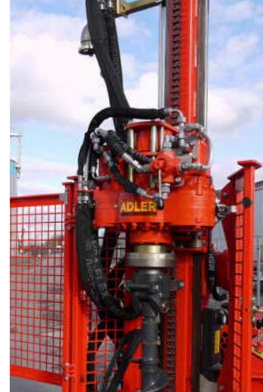
Getriebebohrkopf mit zwei Schaltstufen
