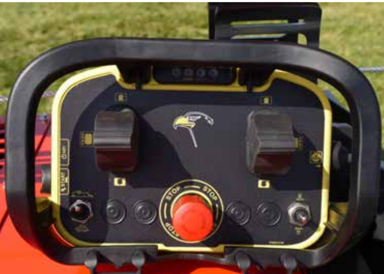
Kabelfernbedienung für den Fahrbetrieb
