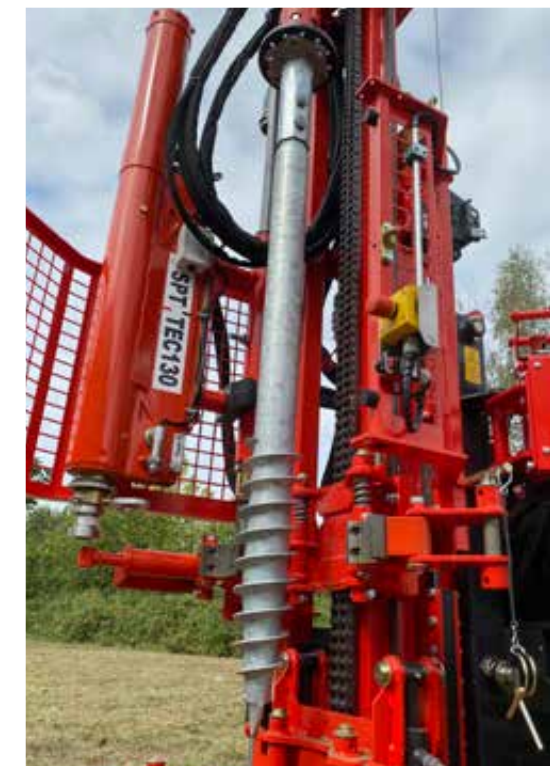
Zum Eindrehen von Schraubfundamenten
