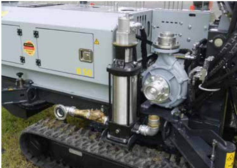
Hochdruck-Frischwasserpumpe
