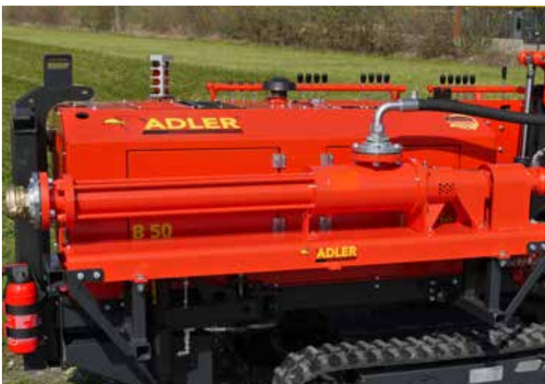
Schneckenpumpe im Einsatz beim Doppelkernrohrbohren
