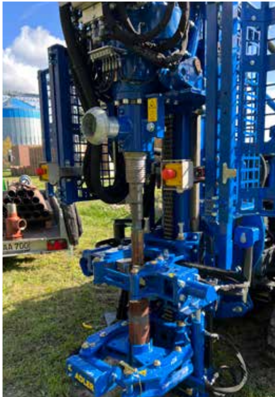
Klemm-Brech-Hubschelle im Einsatz
