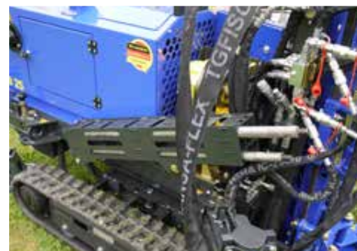
Magazin für Prüfstangen
