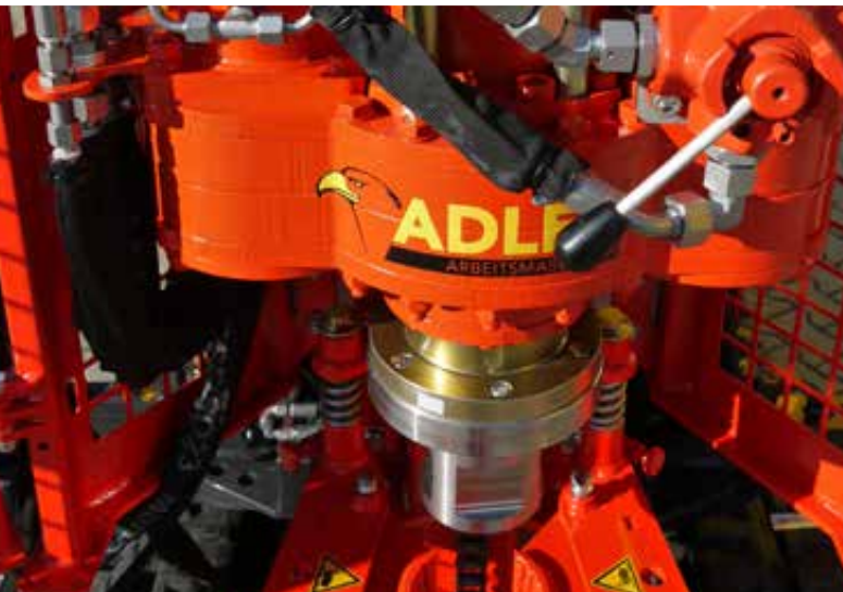
2-stufiger ADLER-Getriebebohrkopf
