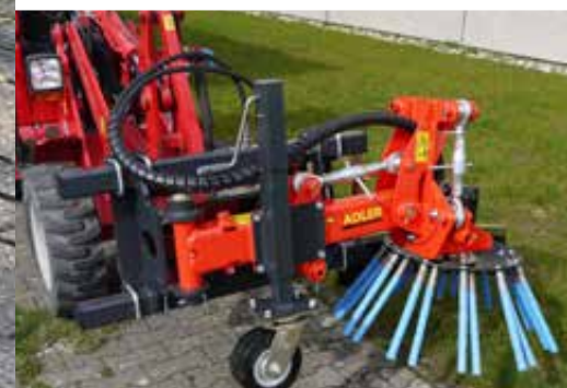
Mechanischer oder hydraulischer Schwenkarm zur Bearbeitung großer Flächen
