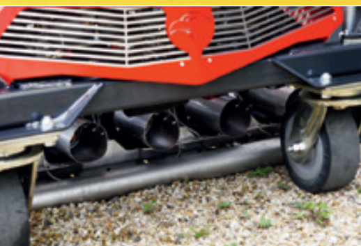
Superelastická kola pro vysoké zatížení zajišťují ochranu infraboxu.
