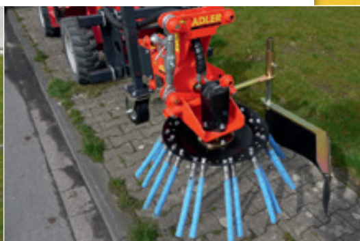
Otočné rameno (mechanicky / hydraulicky) pro ošetření velkých ploch
