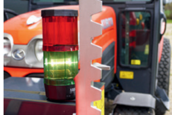
Ukazatel výškového nastavení a signalizační světla pro kontrolu činnosti infraboxu.
