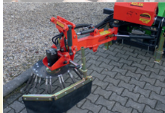
Těžká kartáčová hlava s boční clonou proti odlétávání nečistot
