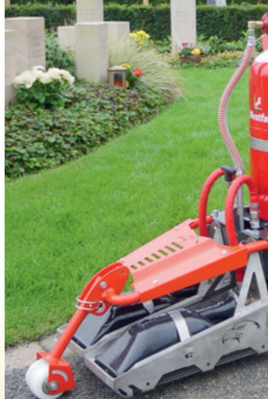
Přední opěrná rolna zajišťuje nastavení infraboxů do optimální výšky.
