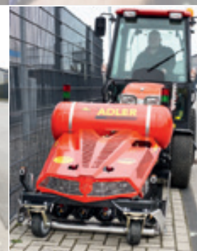
Hydraulický stranový posuv 200 mm napravo i nalevo.
