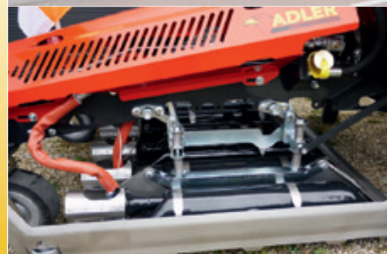
Pružně uložený a pomocí dálkového ovládání nastavitelný infrabox.
