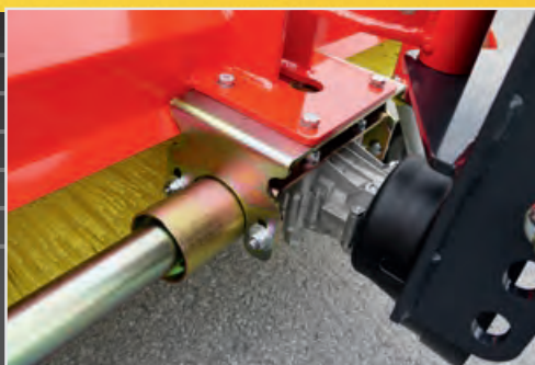
Prędkość obrotowa, kierunek obrotów oraz pozycja przekładni są regulowane.
