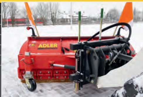
Uniwersalny system montażu z hydraulicznym systemem wychylania (dwa siłowniki hydrauliczne)
