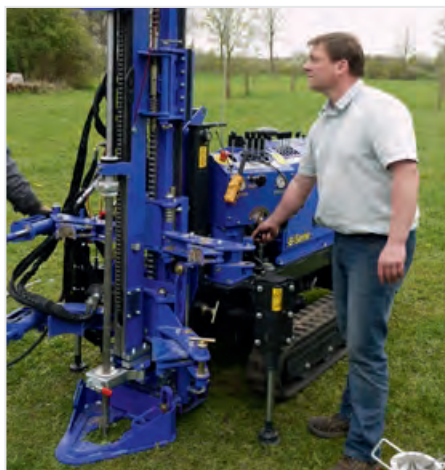
Urządzenie B25 wykorzystane do badania gruntu budowlanego
