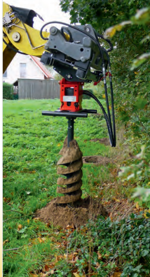
Eksploatacja świda ziemnego na ładowarce kołowej
