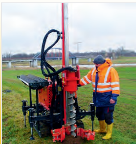
Urządzenie B 25 wykorzystane do sondowania niewybuchów
