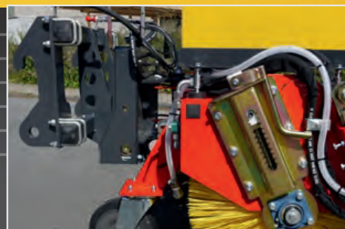
System montażu do ładowarki kołowej z układem wyrównoważenia poprzez prowadnicę rolkową
