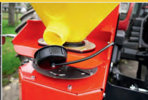
Bezstratny korek spustowy
