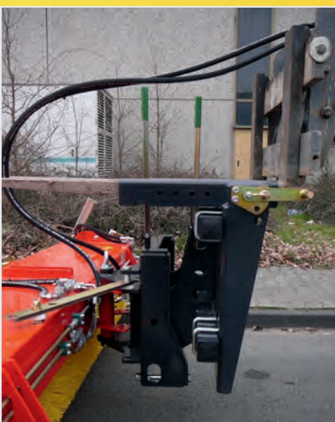
System montażu do ładowarki kołowej za pomocą wczepów widłowych z prowadzeniem rolkowym i układem wyrównoważenia 3D
