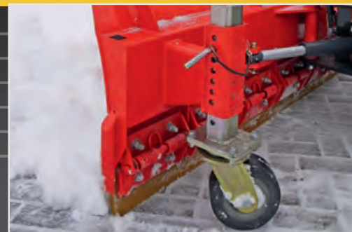
Koła podporowe z regulacją wysokości (200 x 80 mm)
