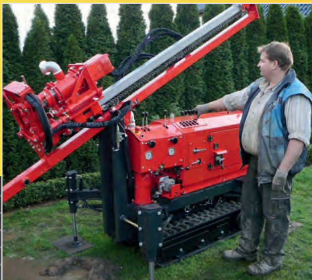
Wysunięcie podpórki przez układ hydrauliczny i ustawienie masztu
