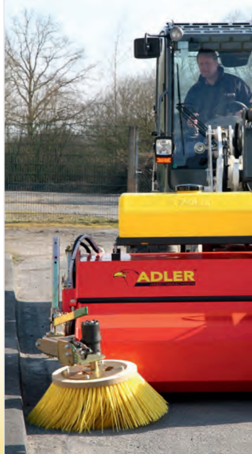
Boczna szczotka zmiatająca oraz zbiornik na wodę o pojemności 240 l jako wyposażenie opcjonalne
