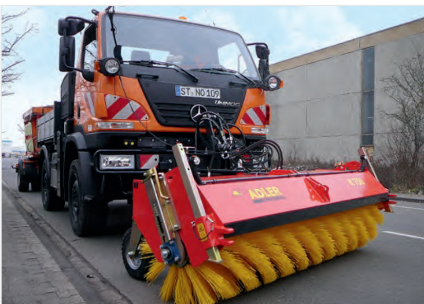
Sprzęg Unimog z urządzeniem wydźwigowym wg DIN 76060
