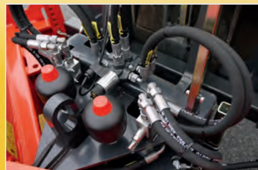
Elektryczny zawór przełączny z zabezpieczeniem przeciwprzeciążeniowym w postaci dwóch zaworów ograniczenia ciśnienia oraz zbiornik azotu
