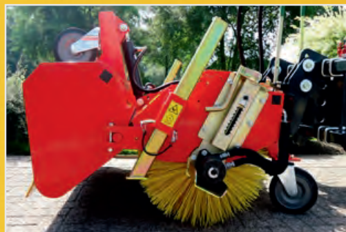
Tryb zamywania bez zbierania zanieczyszczeń, hydrauliczny system opróżniania zbiornika oraz trzecie koło podporowe przy zbiorniku na zanieczyszczenia
