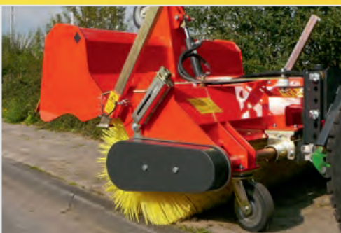
Urządzenia ze zbiornikiem zanieczyszczeń seryjnie wyposażone są w tryb zamywania bez zbierania zanieczyszczeń.
