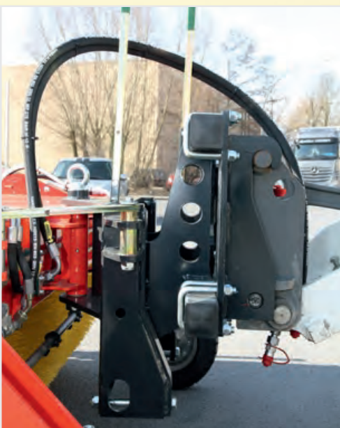
System montażu do ładowarki kołowej z prowadzeniem rolkowym i układem wyrównoważenia 3D
