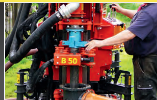
Kruszarka z hydraulicznym zaciskaczem – seryjne wyposażenie wszystkich modeli serii B
