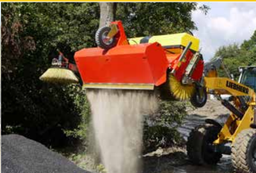
Hydraulische Entleerung des Sammelbehälters
