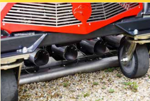
Stoß- und Schwerlastlenkrollen zum Schutz der Infrabox
