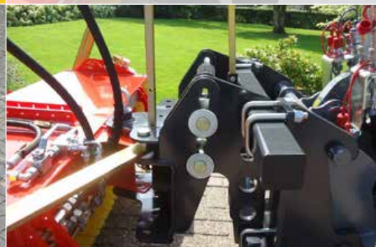
Hofladeraufnahme mit Langlochsystem und 3D-Ausgleich
