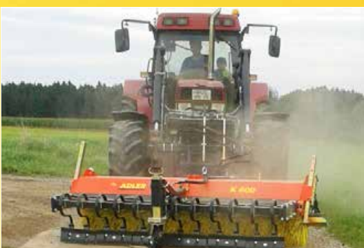
Kratzvorrichtung K 600 ohne Schmutzsammelbehälter
