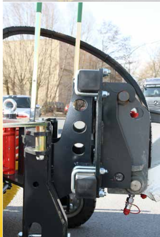
Universalaufnahme mit Rollenschachtsystem und 3D-Ausgleich
