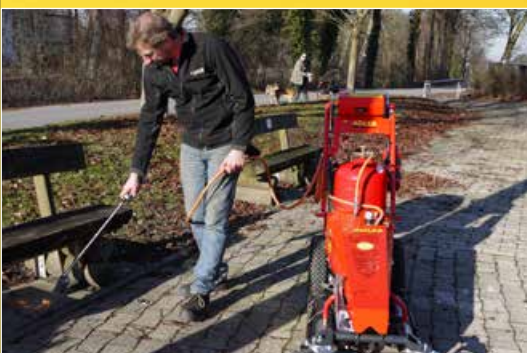
Handbrenner für schwer erreichbare Ecken und Kanten
