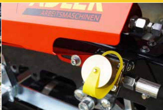
Seitlicher Füllstutzen für LPG-Autogas
