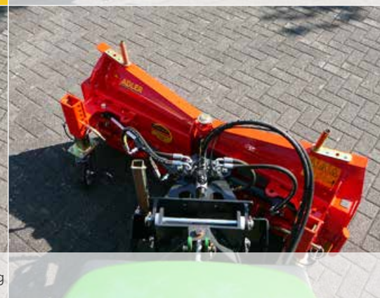
Hofladeraufnahme mit Niveaue Ausgleich und Abstellstütze
