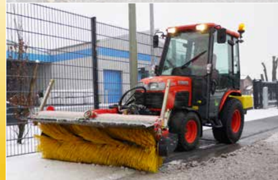
K 560 mit verstellbarem Spritzschutzblech
