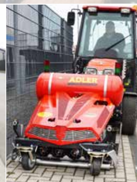
Hydraulische Seitenverschiebung um jeweils 20 cm nach rechts und links
