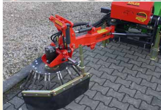
Schwerer Bürstenkopf mit seitlichem Schleuderschutz
