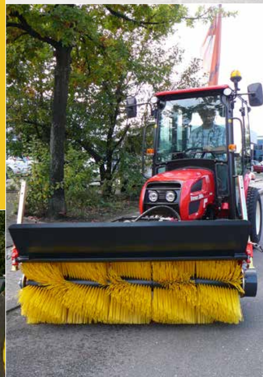
Großer Auswurfwinkel im Maschinenrahmen – ideal zum Schneekehren
