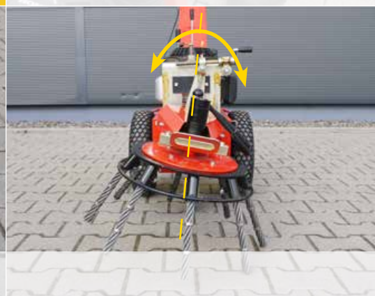
Stufenlose Höheneinstellung des Lenkholmes
