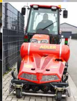
Hydraulische Seitenverschiebung um jeweils 20 cm nach rechts und links
