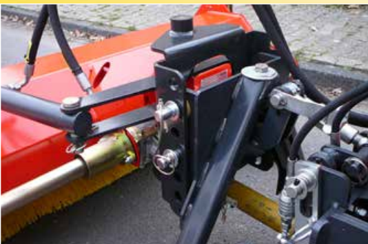
Aufnahmesystem Kuppeldreieck KAT Kommunal
