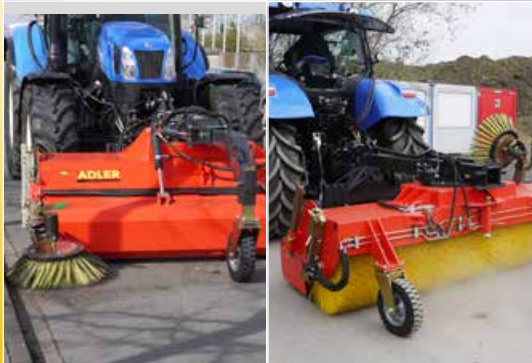
K 750 geeignet für Front- und Heckanbau
