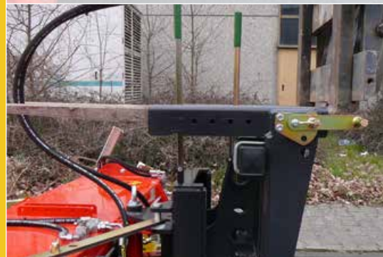
Radladeraufnahme Gabelzinken mit Rollenführung und 3D-Ausgleich
