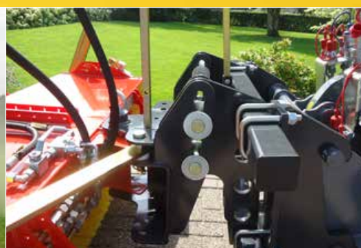
Hofladeranbau mit 3D-Niveausausgleich
