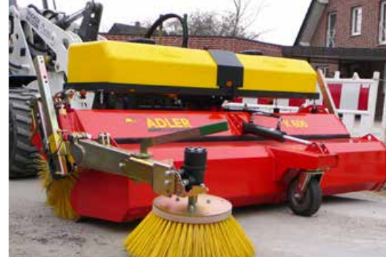
Seitenkehrbesen und Wassersprüheinrichtung als Option
