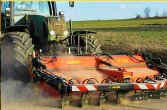
K 750 mit Kratzvorrichtung und Schmutzsammelbehälter
