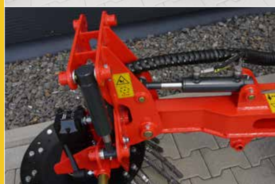
Hydraulisch einstellbare Längs- und Querneigung, wahlweise auch mechanisch
