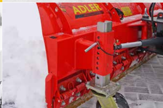
Höhenverstellbare Stützräder (200 mm x 80 mm)
