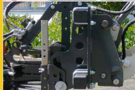
Hofladeraufnahme mit Niveaue Ausgleich und Abstellstütze
