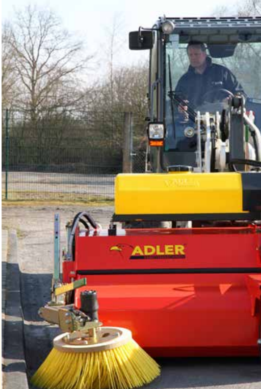
Seitenkehrbesen und Wassertank 240 l als Option
