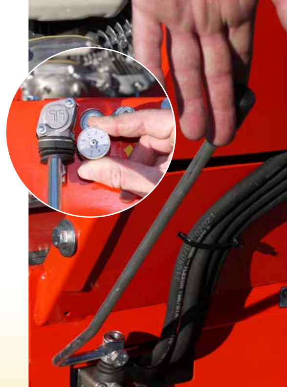
Gestängesteuerung und stufenloser Fahrentrieb
