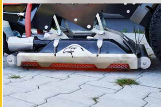
Höhenverstellbare Infrabox zur Anpassung an Wege und Flächen
