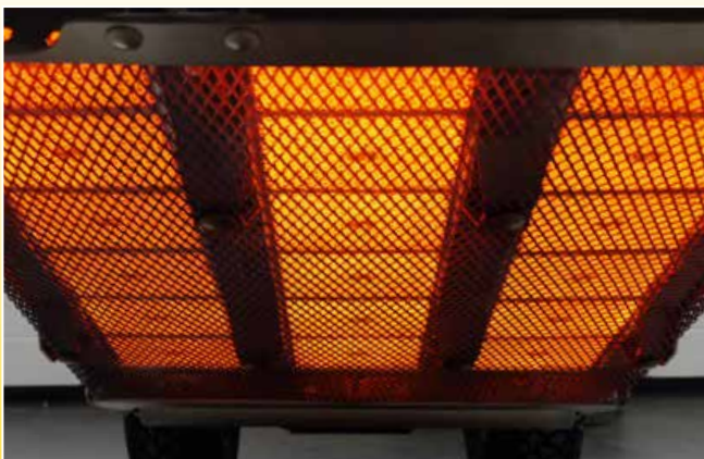
Die Infrarotstrahlung der ca. 1000 °C heißen Keramik-Infrarotstrahler zerstört Zellstruktur und Eiweiß des oberflächlichen Pflanzenmaterials und reduziert die Keimfähigkeit des vorhandenen Samenpotenzials. Bereits nach 1 bis 2 Tagen wird die Schädigung der Wildkräuter sichtbar.
