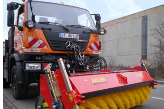
Unimogaufnahme mit Geräteaushebung nach DIN 76060
