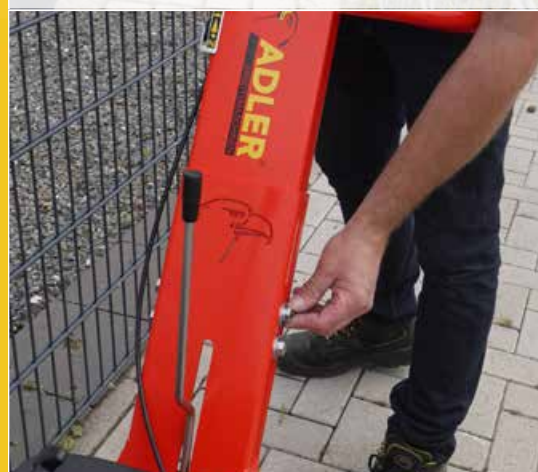
Stufenlose Höheneinstellung des Lenkholmes
