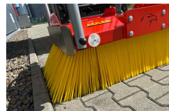
Effektives randnahes Kehren mit keilförmigen Seitenkehrleisten (optional)
