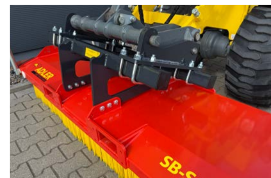
Schnellwechselsystem für Rad- und Frontlader
