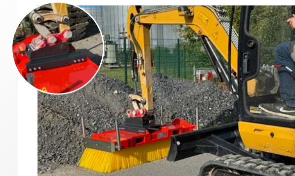
... und mit Schnellwechselsystem am Bagger
