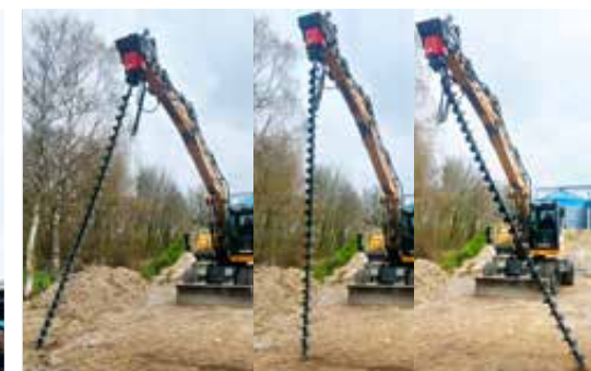
Einfaches Handling – dank großem integrierten 2D-Pendelweg
