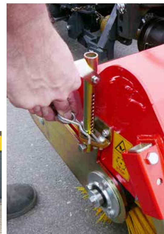
Bürstenverstellung über Stecksystem
