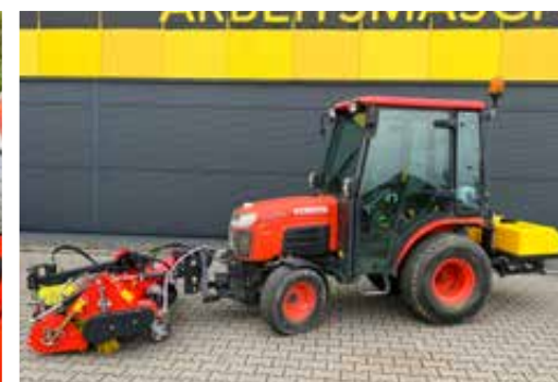
Wassersprüheinrichtung (120 l oder 300 l) am Heckträger als Option
