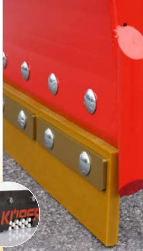
Vereisungsfreie Federklappen, serienmäßig mit Randabweiser (verschiedene Verschleißleisten im Sortiment)
