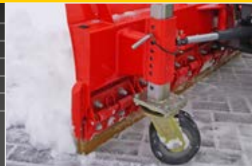
Höhenverstellbare Stützräder (200 x 80 mm)
